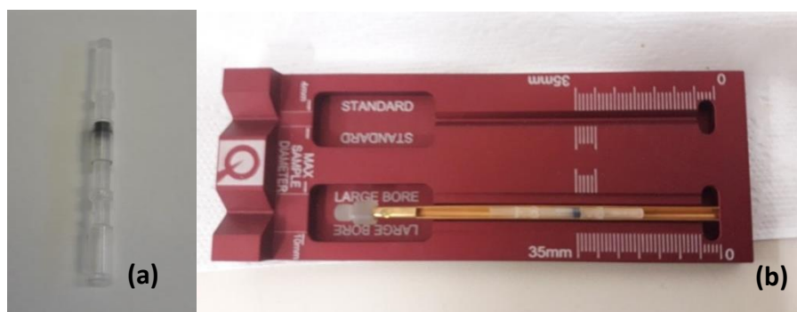
Figura 3. 13 - (a) porta amostra usado no PPMS, (b) porta amostra em suporte para fixação da amplitude do campo oscilante na extremidade do flange.
