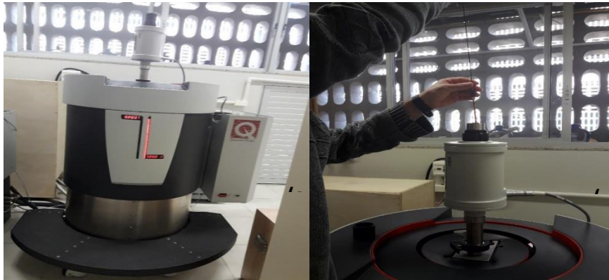
Figura 3. 12 - (a) visão geral do PPMS no laboratório, (b) inserção do flange no experimento.
