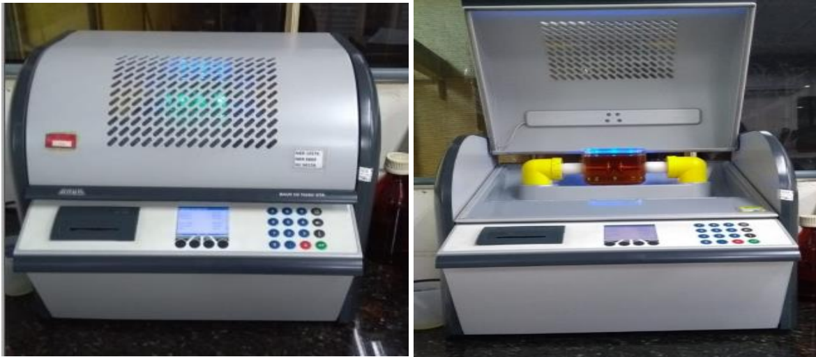
Figura 14 - Equipamento de determinação da rigidez dielétrica.
