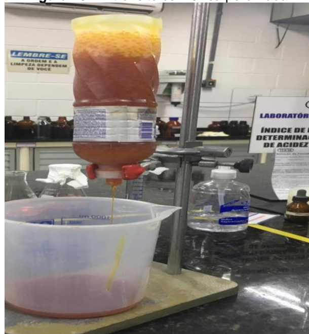
Figura 10 - Filtro feito com sílica perolizada.
