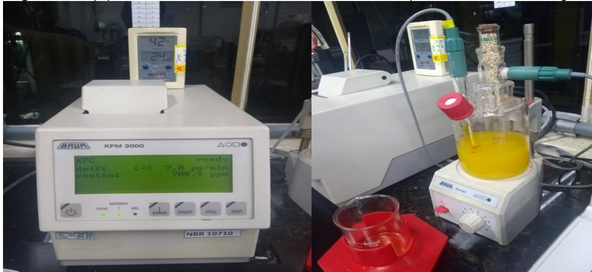
Figura 13 - Equipamento BAUR AGUAMETER KFM3000, utilizado para determinar teor de água.
