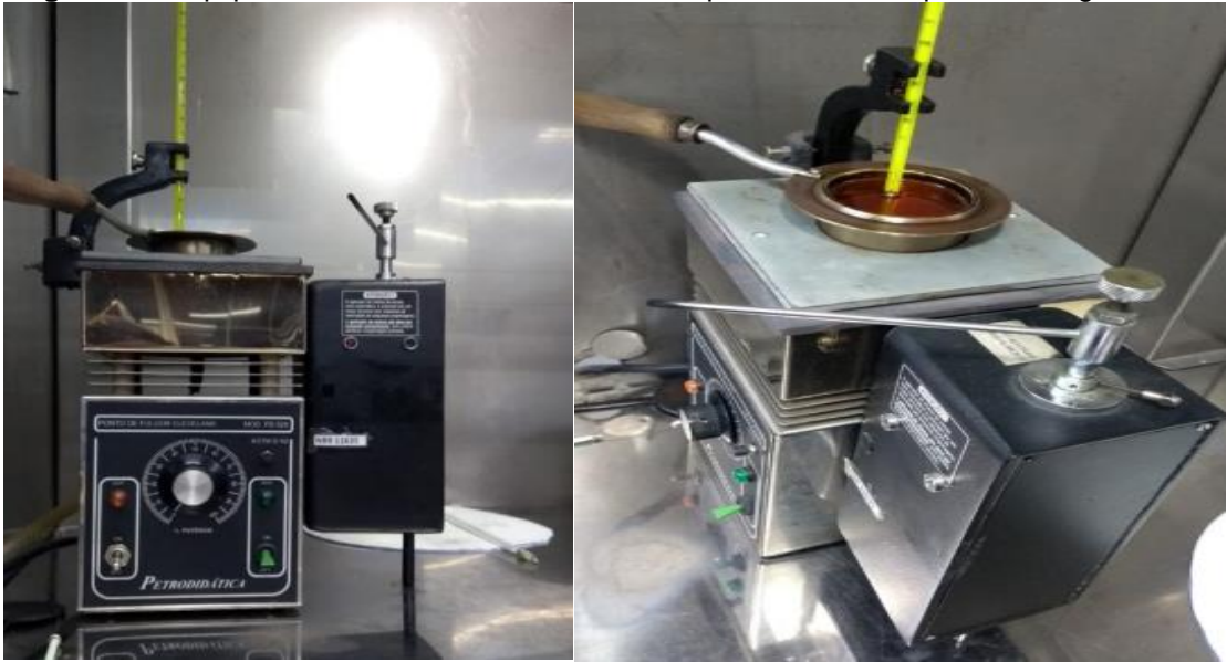
Figura 12 - Equipamento vaso Cleveland, utilizado para determinar ponto de fulgor.
