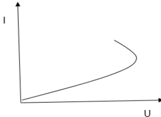
Figura 3 - Lei de variação da corrente com a tensão nos dielétricos sólidos.
