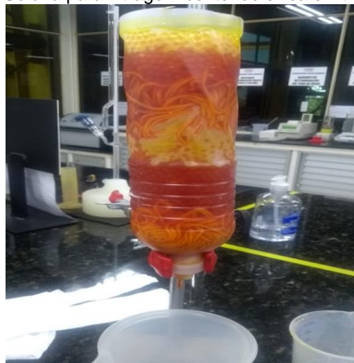
Figura 11 - Coluna para filtragem contendo sílica e filtro de 1 micra.
