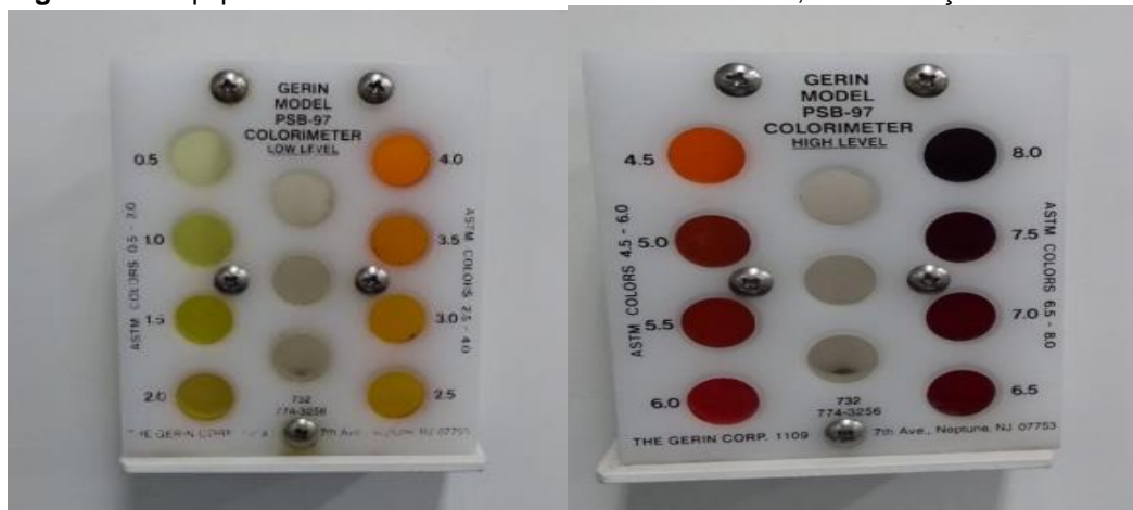
Figura 15 - Equipamento colorímetro GERIN modelo PSB-97, determinação da cor.
