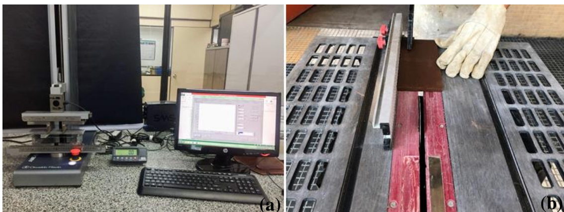
Figura 30 – Prensa de ensaio à flexão (a) Corte dos corpos de prova à flexão (b)
