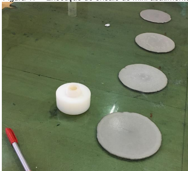
Figura 17 – Execução do ensaio de mini abatimento
