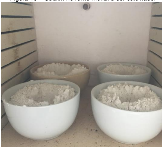
Figura 10 – Caulim no forno mufla, a ser calcinado.
