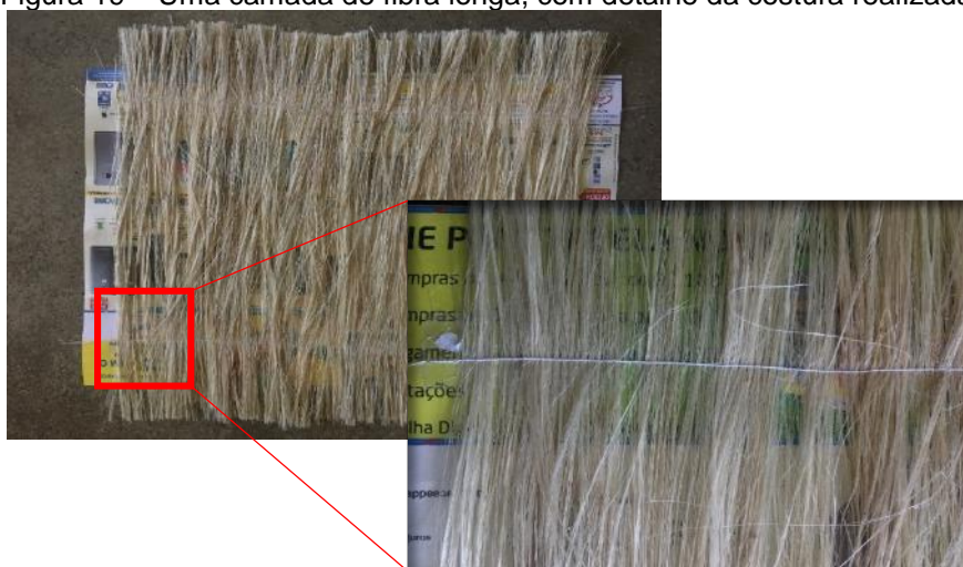
Figura 19 – Uma camada de fibra longa, com detalhe da costura realizada.
