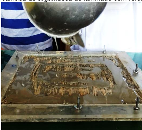
Figura 20 – Última camada de argamassa do laminado com reforço de fibras longas.
