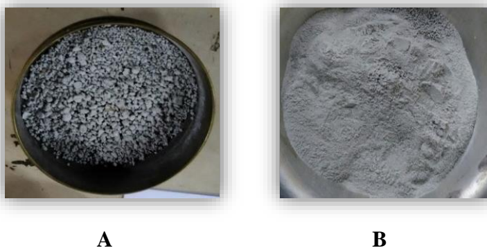
Figura 13. Produto obtido no peneiramento grosso (A) e produto obtido no peneiramento fino (B) do cal de carbureto.
