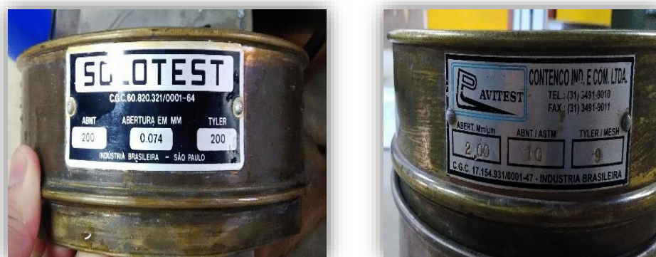
Figura 8. Peneiras utilizadas na análise granulométrica, com abertura mínima #2 Fonte: Autor, 2018
