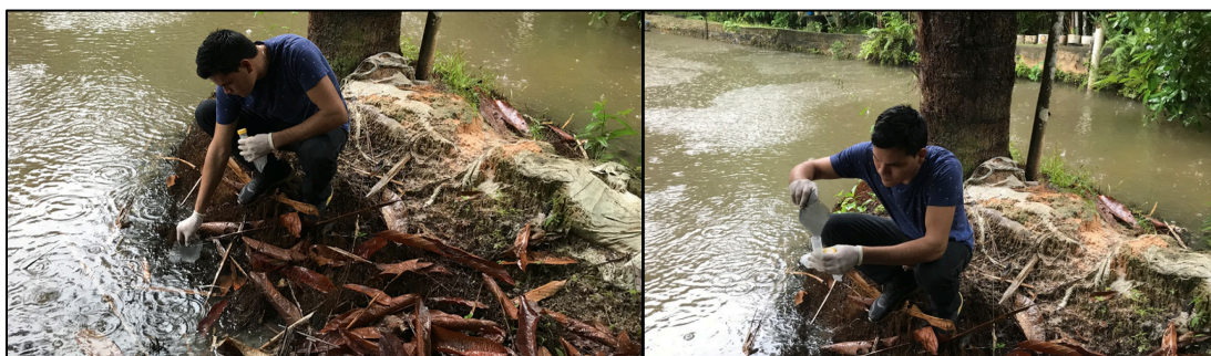
Figura 8. Coleta de água utilizando a malha de aço e tubo falcon.
