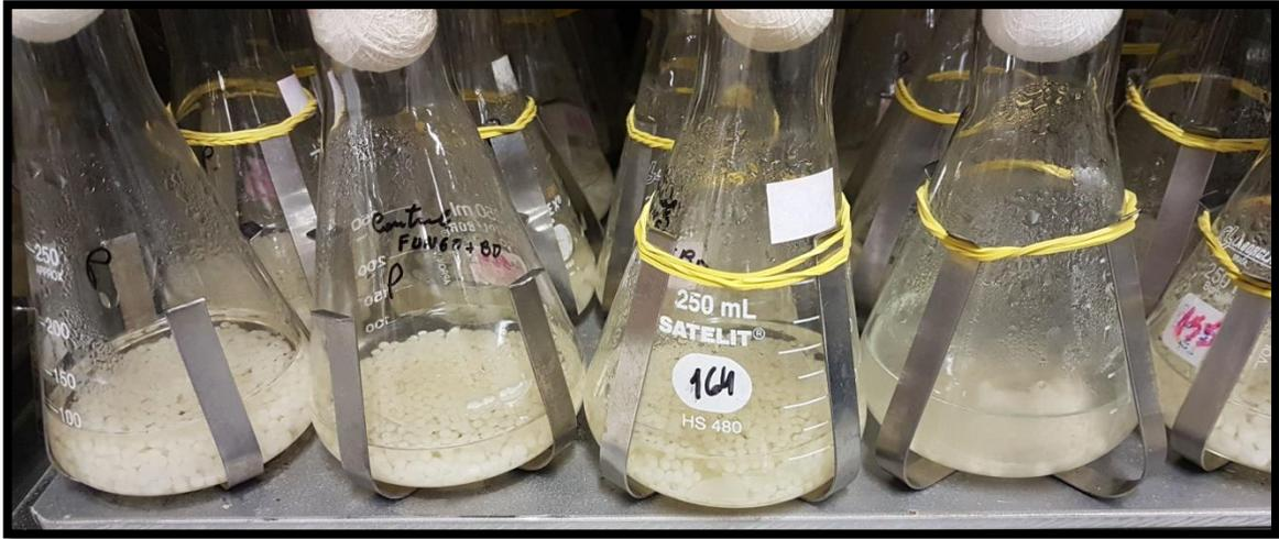
**Figura 12** - Cultivo em meio líquido BD (Batata Dextrose), reduzido de glicose, realizado a partir de suspensão de esporos, com crescimento de 5 dias, sob agitação a 28 °C.
