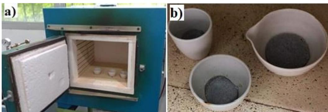
**Figura 12** - Procedimento de cinzas: a) mufla e b) cinzas após mufla.
