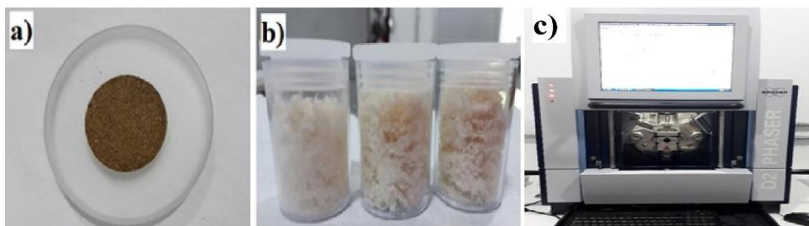
**Figura 20** - Preparação da amostra para análise de DRX: a) fibras *in natura* em porta-amostra b) celulose e nanoceluloses para análise e c) Difratômetro de raios X.
