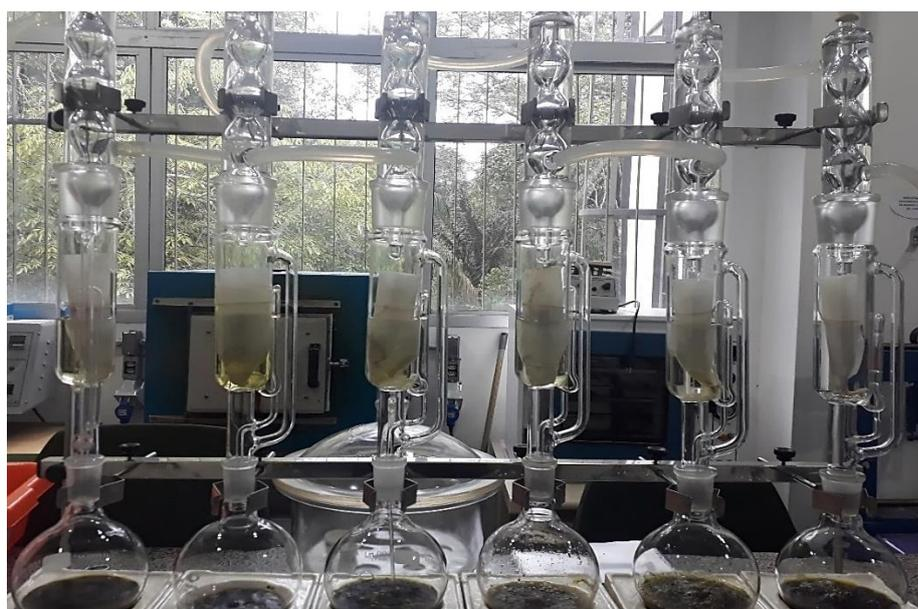
**Figura 13** - Aparelhagem de soxhlet com a amostra em ebulição.
