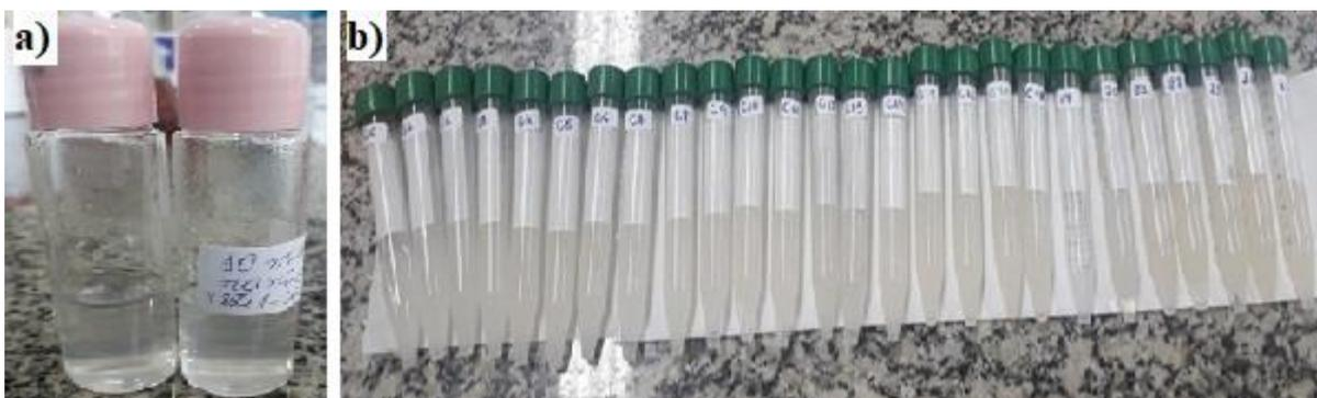
**Figura 23** – Amostras para análise de DLS: a) suspensões de CNC e b) amostras de CNF
