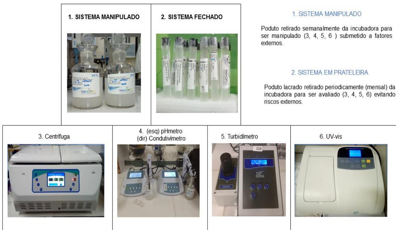
**Figura 5:** Esquema sistema manipulado e em prateleira. Fonte: Autor.
