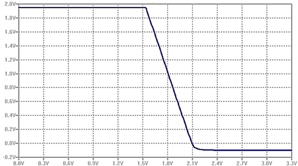
Figura 54: Variação da saída V_{out} devido à variação de 5% na tensão de limiar do transistor tipo N, em 200 simulações, pH 7 (Elaborada pelo autor).
