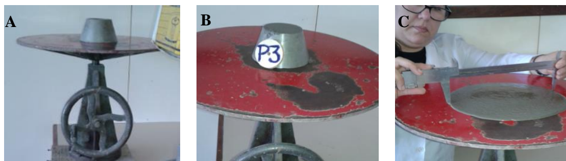
Figura 23. Ensaio de consistência. A- Argamassa e equipes utilizados. B - Cone preenchido de argamassa, C- Medição do espalhamento.
