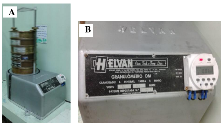
Figura 19. A- Peneiramento da areia no tamisador elétrico. B- Equipe elétrico para fazer granulometria (Granulômetro).
