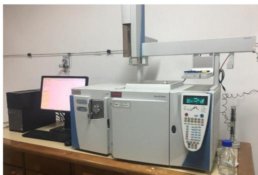
Figura 18. Cromatógrafo Trace GC Ultra, acoplado ao espectrômetro ISQ Single Quadrupole MS da Thermo Scientific.
