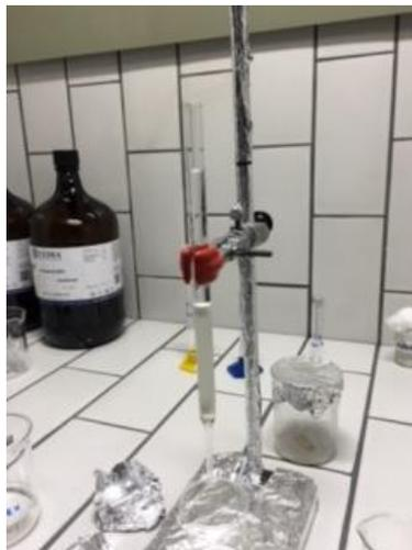
Figura 17. Fracionamento e limpeza dos extratos realizados em colunas cromatográficas. Fonte: a própria autora.
