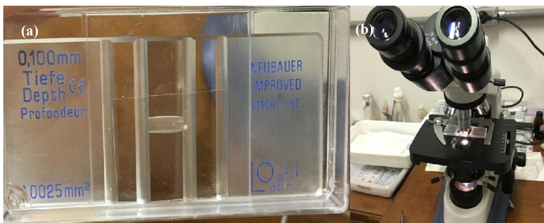
Figura 14. (a) Hemacitômetro tipo Neubauer: lâmina retangular em forma de H com compartimentos e subcompartimentos. (b) Microscópio para leitura da lâmina. *Fonte: a própria autora.*
