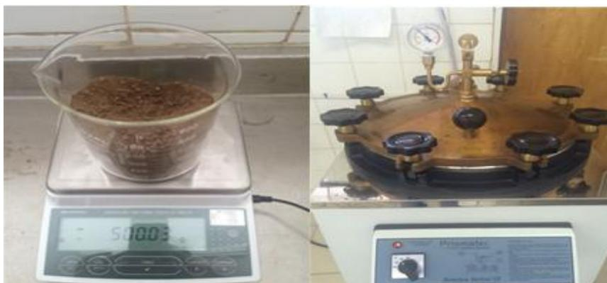
Figura 13. Pesagem da amostra de solo e autoclavagem para garantir sua total esterilização. *Fonte: a própria autora.*
