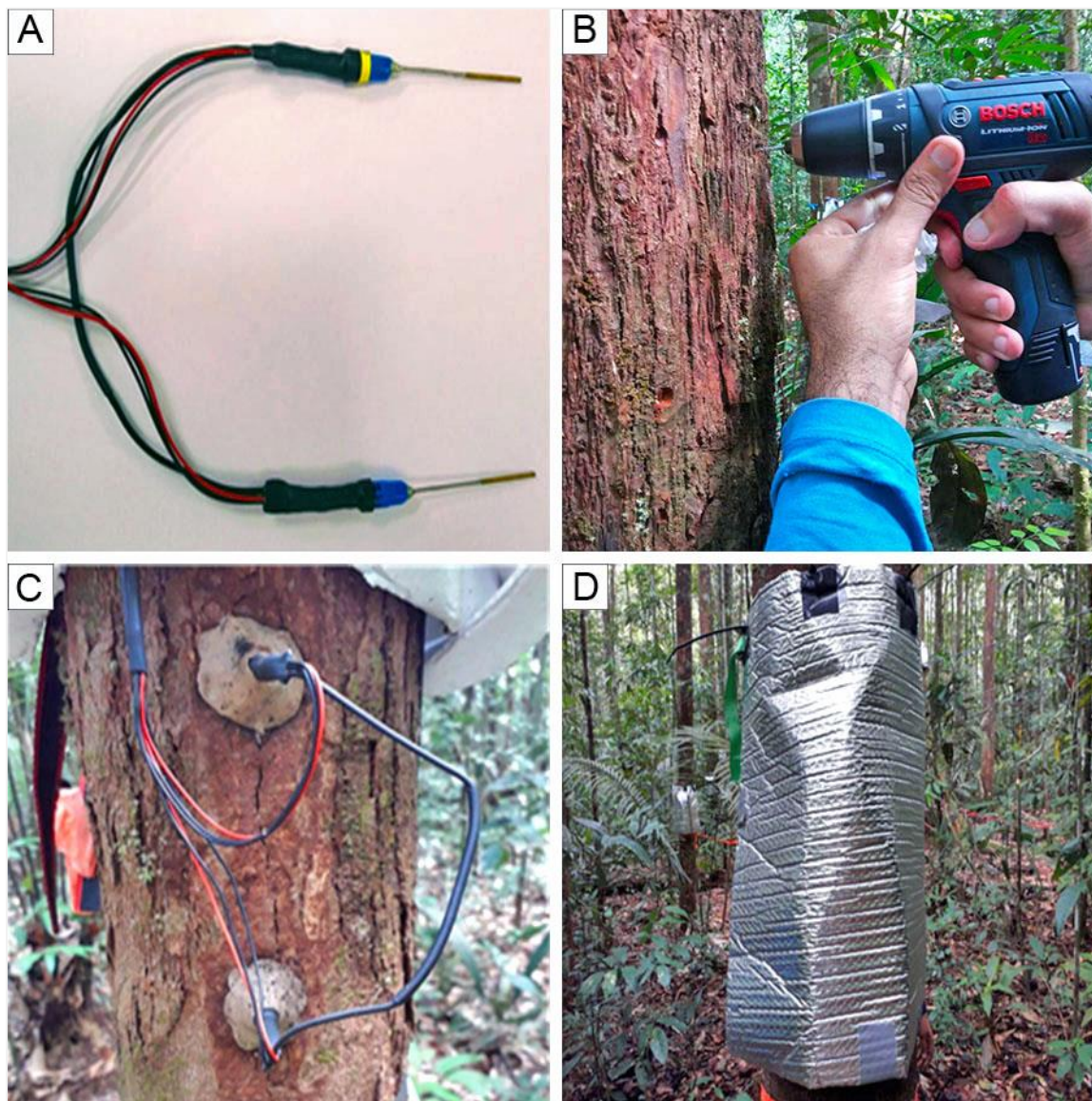
Figura 5. Sensor modelo SF-G (ECOMATIK) com duas agulhas (A), processo de perfuração das árvores (B), sensor instalado a 1,30 m acima do solo (C) e protetor isolante térmico (D).
