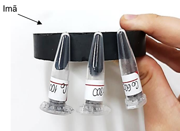
Figura 1: Nanopós de \text{CoFe}_2\text{O}_4 obtidos pelo método Sol-Gel Proteico, suspensos por ação magnética. Fonte: Próprio Autor.
