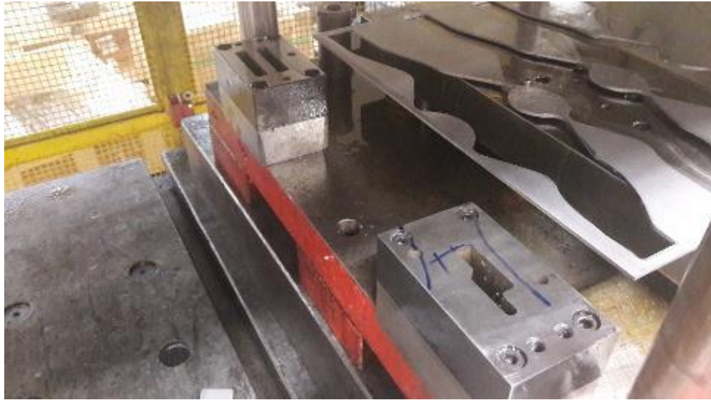
Figura 37 – Ferramenta de estampagem com aproveitamento de matéria-prima
