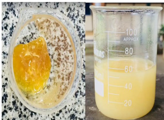
Figura 18-Melhora de trabalhabilidade da resina de breu comercial extraída em acetato solubilizada em etanol.
