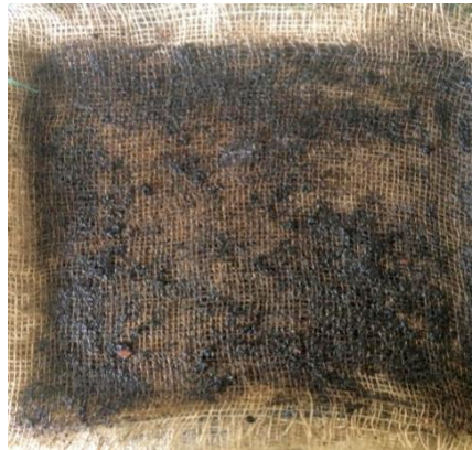
Figura 32-Impermeabilização do tecido de juta e malva, em meio ao revestimento de breu in natura.
