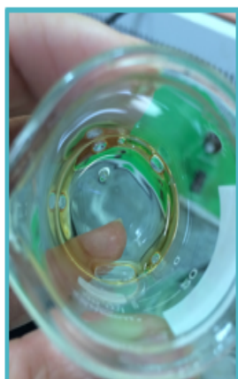
Figura 15-Resíduo de resina de breu extraído em etanol, massa residual resistente a tetraidrofurano.
