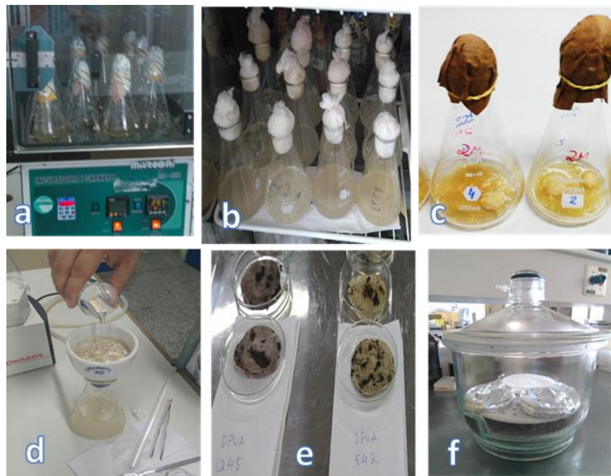
Imagem 5 – Etapas do cultivo e da preparação da biomassa – cultivo sob agitação em shaker (a); cultivo estático em BOD (b); micélios após o período de crescimento em meio líquido (c); lavagem e filtração dos micélios (d); micélios recém-lavados e filtrados (e); micélios no dessecador (f)
