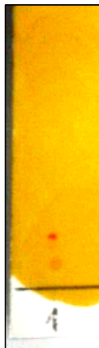
Figura 11: CCDC revelada com reagente de Dragendorff, evidenciando a presença de alcaloide. Sistema de eluição utilizado AcOEt/Acetona 7:3
