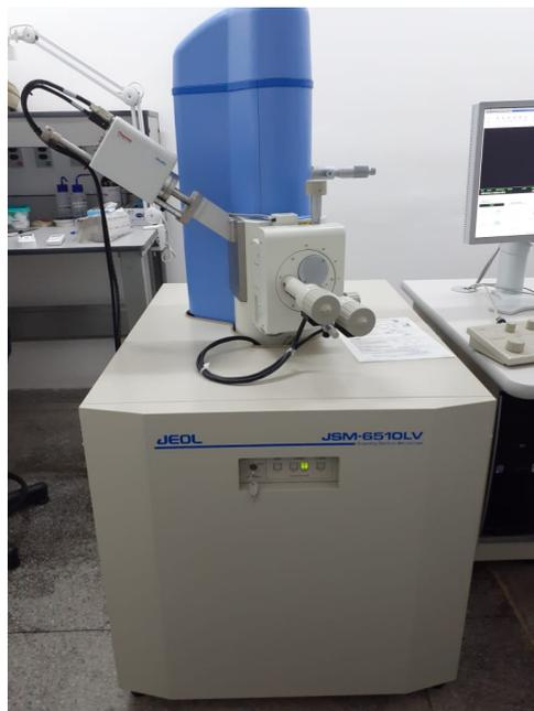
**Figura 4.7:** Microscópio eletrônico de varredura JEOL JSM-65610LV do departamento de física da UFS
