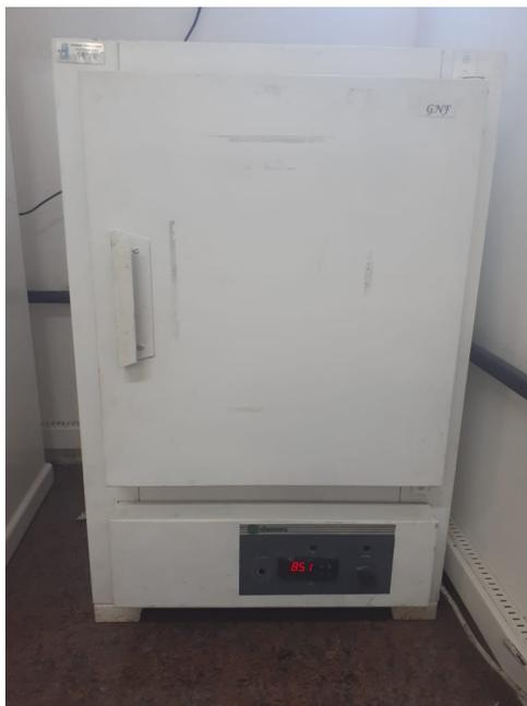
**Figura 4.5:** Estufa utilizada durante a secagem das pastilhas.
