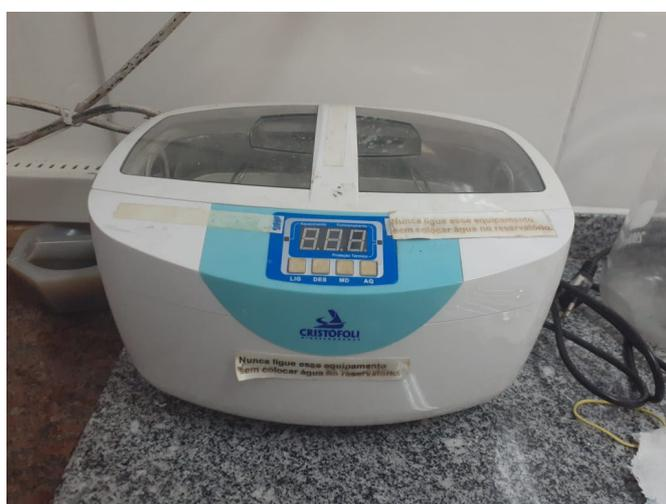
**Figura 4.4:** Dispositivo utilizado para banho ultrassônico. Fonte:
