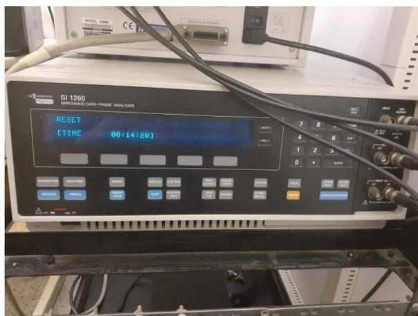
**Figura 4.10:** Equipamento usado para medir impedância elétrica.
