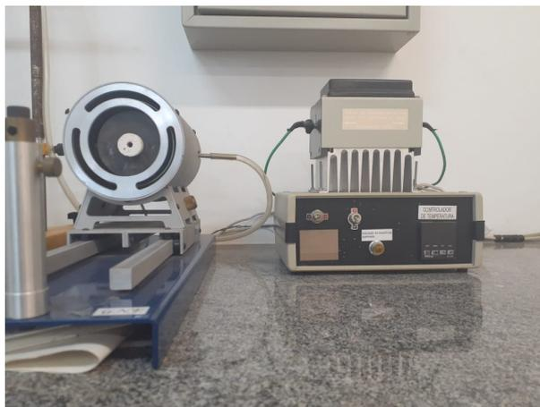
**Figura 4.3:** Forno tubular de platina utilizado para a sinterização.
