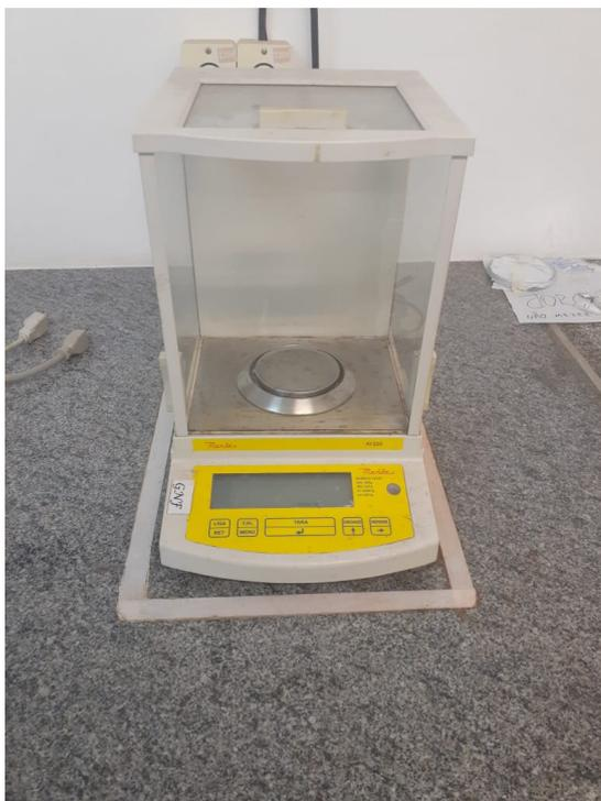
**Figura 4.1:** Balança utilizada para a medição da massa do pó cerâmico. Fonte: Autor
