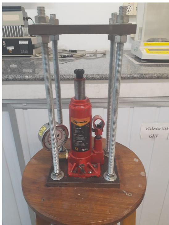
**Figura 4.2:** Prensa hidráulica utilizada para o pastilhamento.
