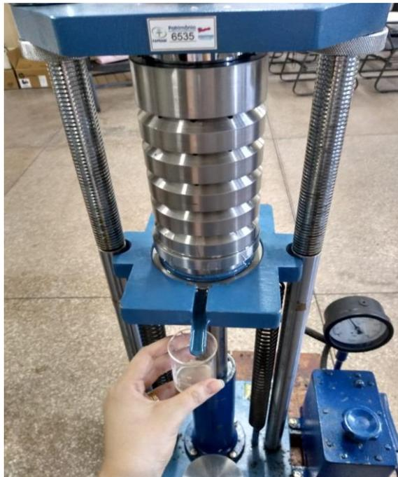
Figura 12: Prensa mecânica utilizada para extração do óleo
