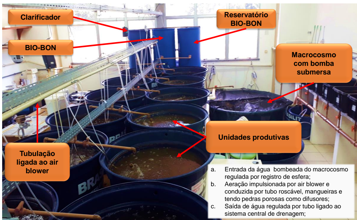
Figura 01. Disposição do sistema BFT usado para produção de tambaqui ( Colossoma macropomum ) durante o período experimental
