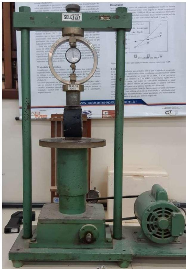
Figura 8 - Detalhes da prensa de ensaio de resistência à tração por compressão diametral
