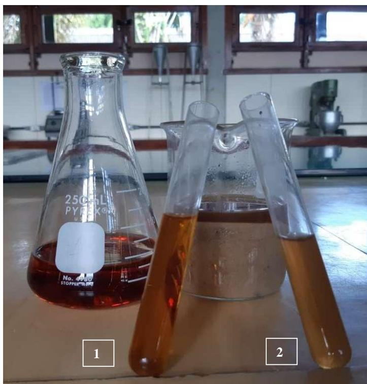
**Figura 17 - Ensaio de impurezas orgânicas na areia**
