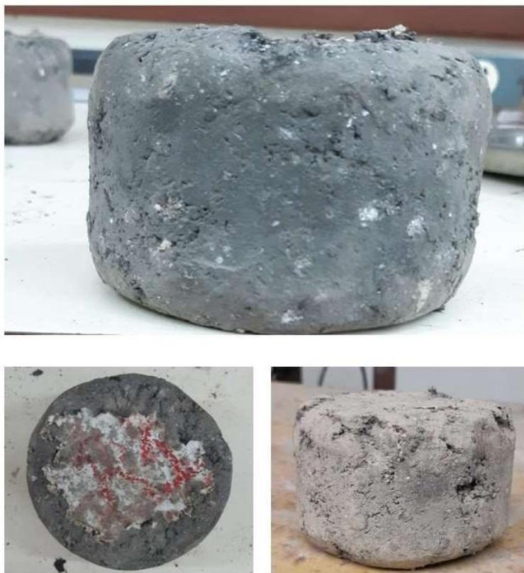
**Figura 24 - Corpo de prova após ensaio cântabro em diferentes perspectivas**
