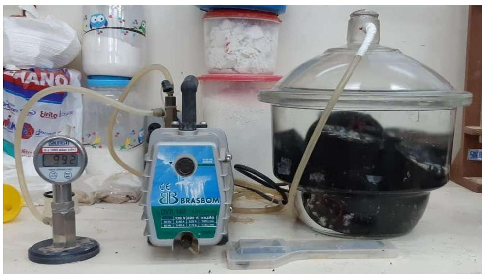
Figura 7 - Detalhes do ensaio de umidade induzida (Lottman modificado)
