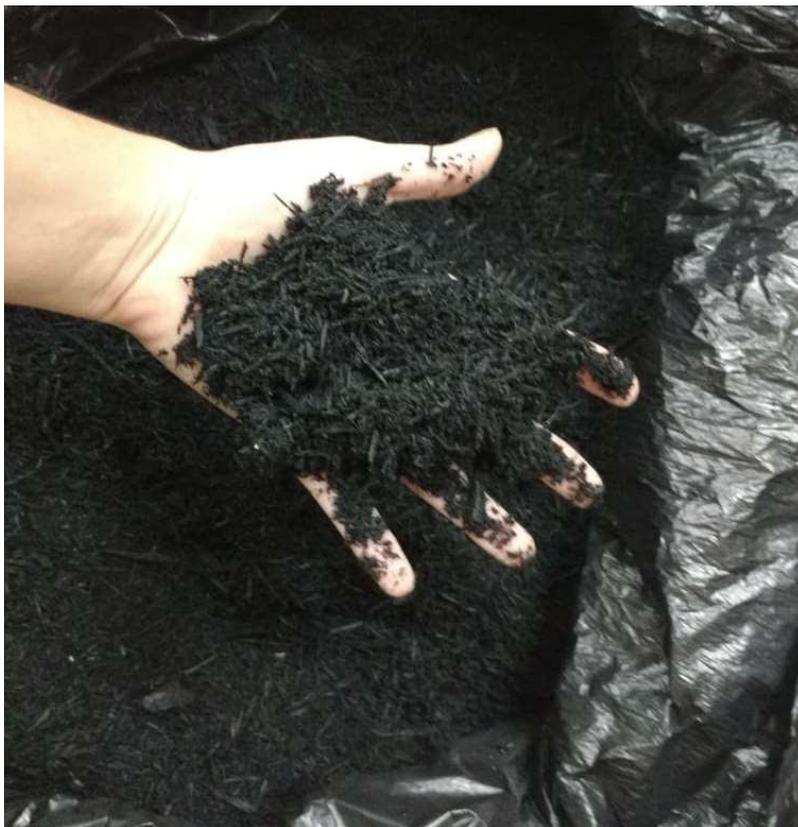
**Figura 13 - Raspa de borracha utilizada no trabalho**
