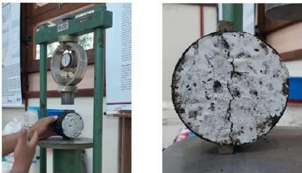
**Figura 26 - Ensaio de resistência à tração por compressão diametral em perspectivas diferentes**
