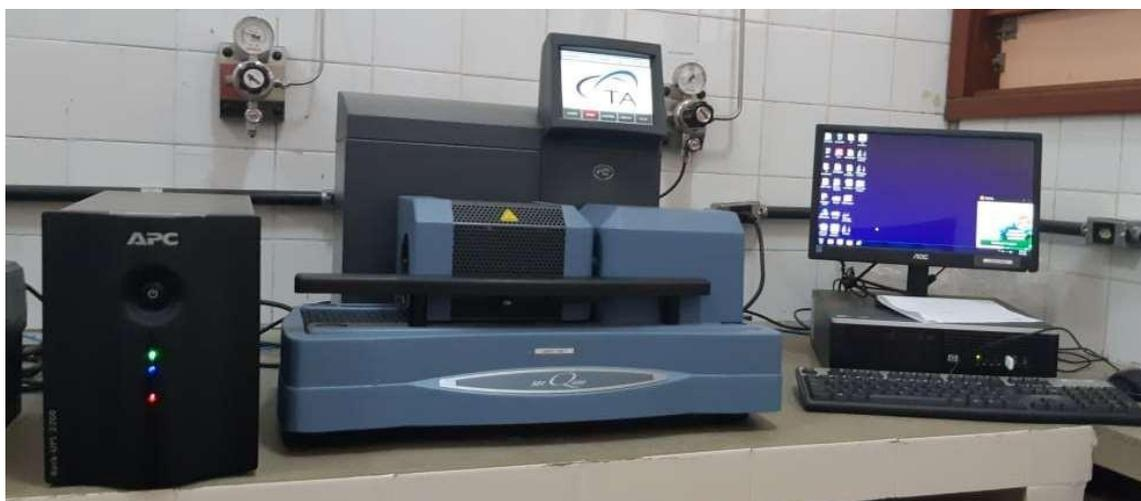
**Figura 15 - Equipamento de análise termogravimétrica**
