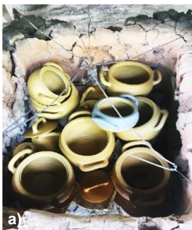
Figura 45 - a) panelas arrumadas no forno para serem queimadas; b) forno queimando; c) jutaica descascada; d) jutaica derretendo; e) Eudes molda jutaica no pau; f) jutaica preparadas; g) jutaica sendo passada em panela quente; h) filho e pai finalizam as últimas panelas
