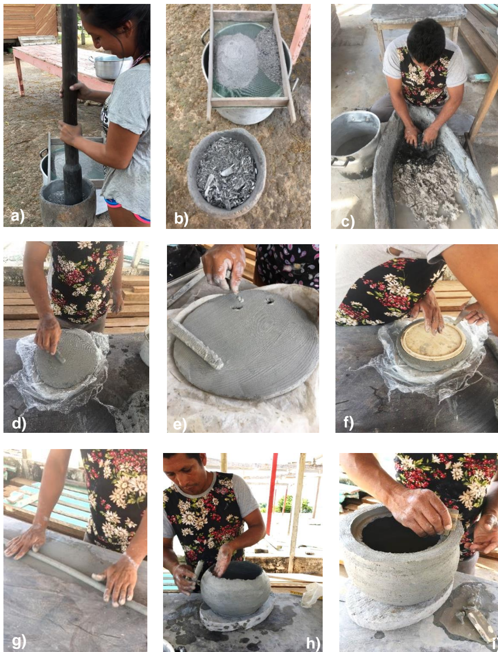
Figura 43 - a) pilando o caripé; b) peneira com diferentes gramaturas de caripé; c) Eudes mistura caripé no barro; d) alisando o barro com espiga de milho; e) "tirando o vento" de dentro do barro; f) recortando a base da peça; g) troça; h) puxando a troça e aumentando a parede da peça; i) dando acabamento na boca da panela
