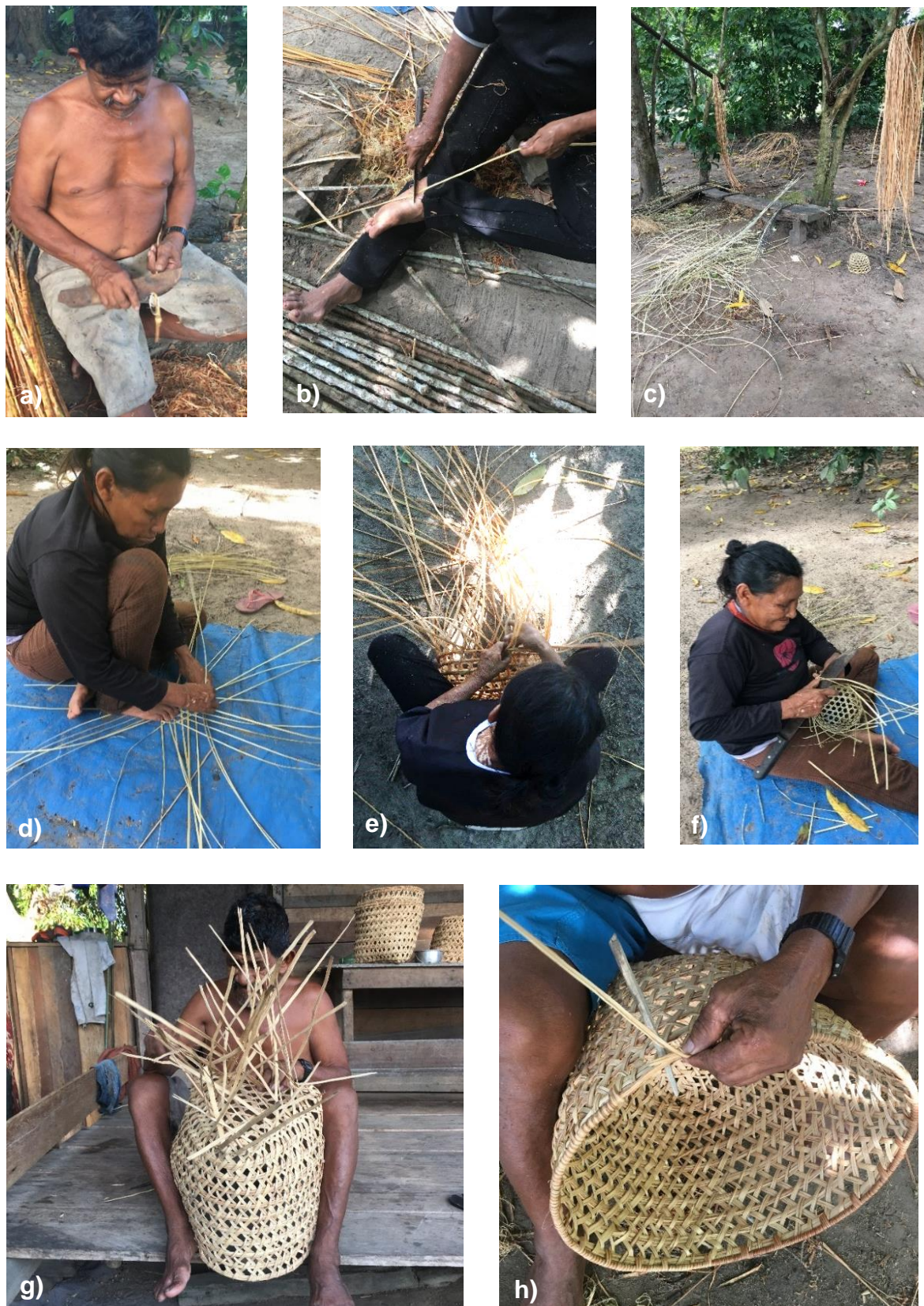
Figura 48 - a) corte das talas com terçado velho; b) pé serve se apoio para dar acabamento final na tala; c) material separado para feitura do paneiro; d) início da base do paneiro; e) feitura da parede do paneiro; f) acabamento de algumas partes do paneiro; g) volta do fundo do paneiro; h) arremate do topo do paneiro com ajuda de pedaço de pau
