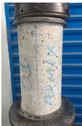
Figura 15: Ensaio de resistência a compressão axial (RCA)
