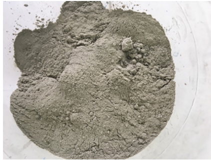
Figura 11: Aspecto do aditivo catalisador cristalino fornecido na forma de pó
