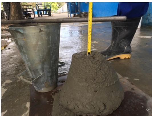
Figura 13: Aferição do abatimento ( slump test )
