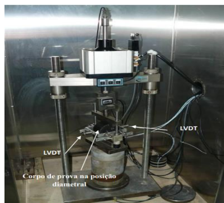
Figura 3.11- Ensaio de Módulo de Resiliência na UTM 14
