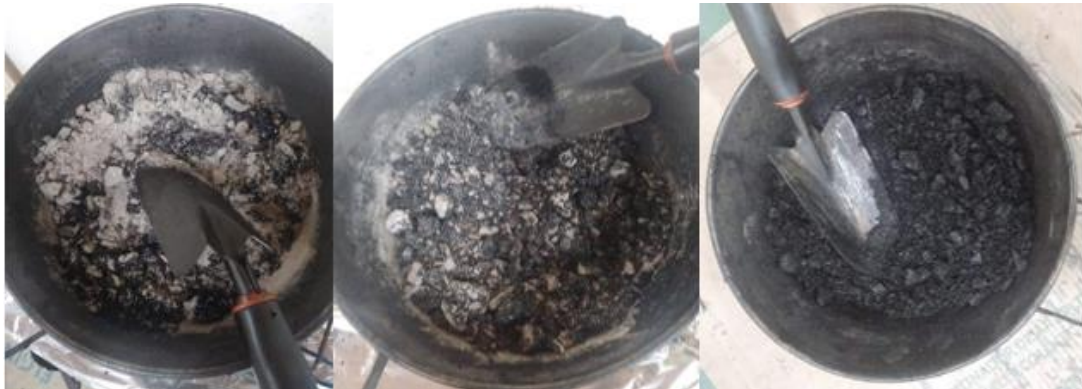
Figura 3.7- Processo de homogeneização da mistura asfáltica
