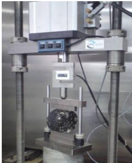
Figura 3.10- Ensaio de Resistência à Tração na UTM 14
