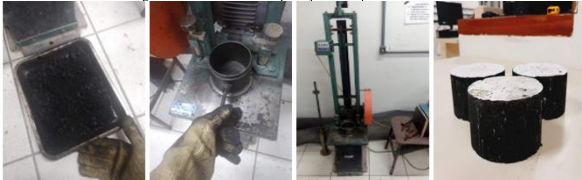
Figura 3.9- Processo de compactação dos espécimes Marshall
