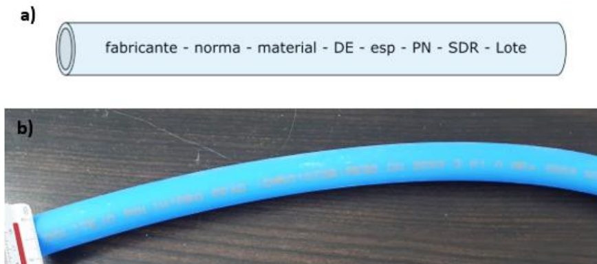
Figura 2.1- (a) Designação mínima para tubos de PE, (b) Marcação hot stamping
