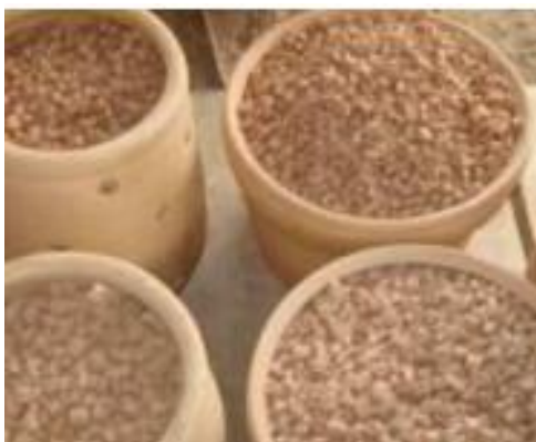
Figura 3.1 – a) ASAC; b) areia residual; c) Cimento asfáltico de petróleo
