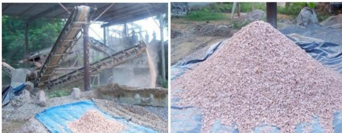
Figura 3.2: ASAC após processo de britagem
