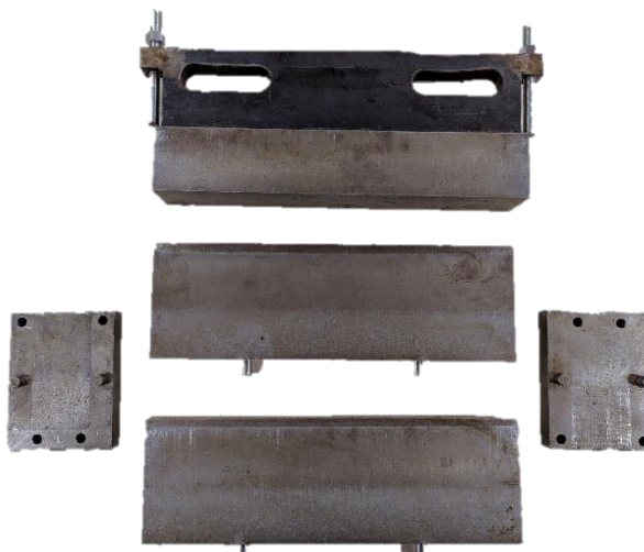
Figura 3.4 – Sistema de moldagem dos corpos de prova prismáticos
