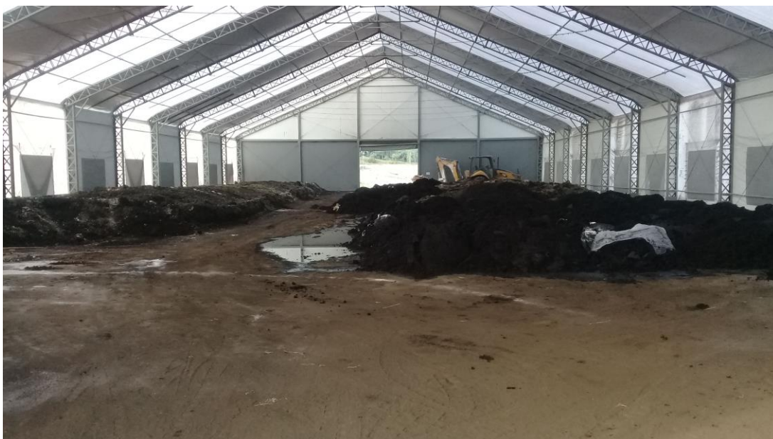
Figura 15. Lodo in natura com tratamento prévio (inertização com cal).
