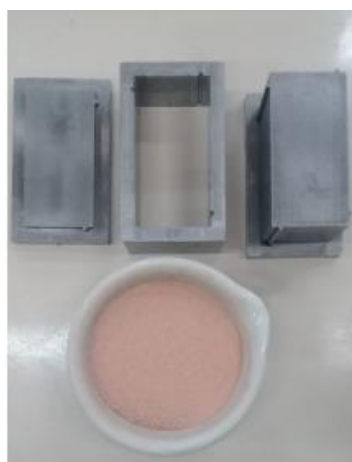
Figura 17. Matriz utilizada para confeccionar os corpos de provas.
