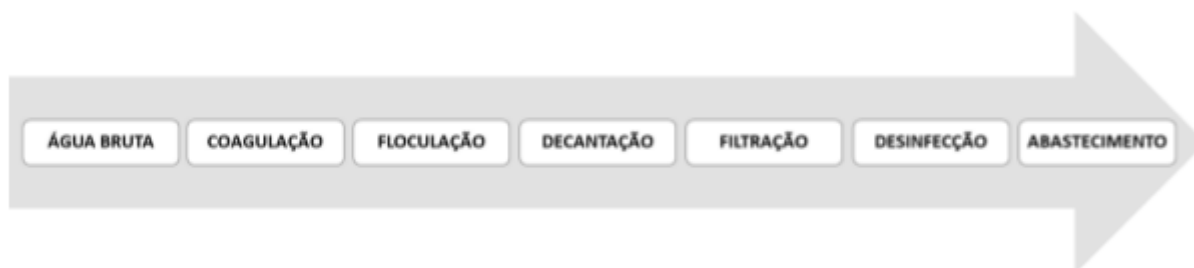
Figura 10. Sistema de tratamento de água convencional ou completo.
