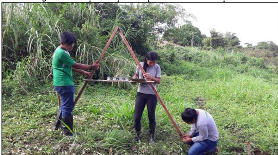
Figura 9: utilização do Aparato-A para coletar a altura no ponto 1
