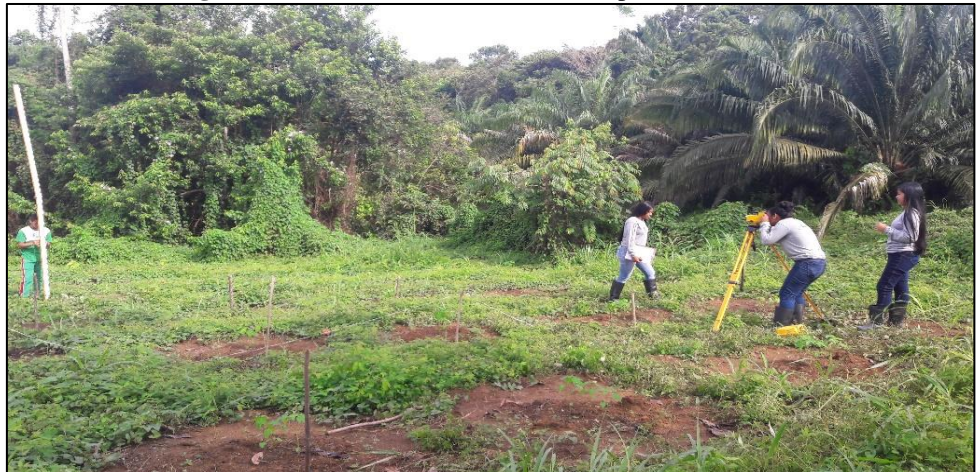
Figura 12: Nivelamento Geométrico Simples
