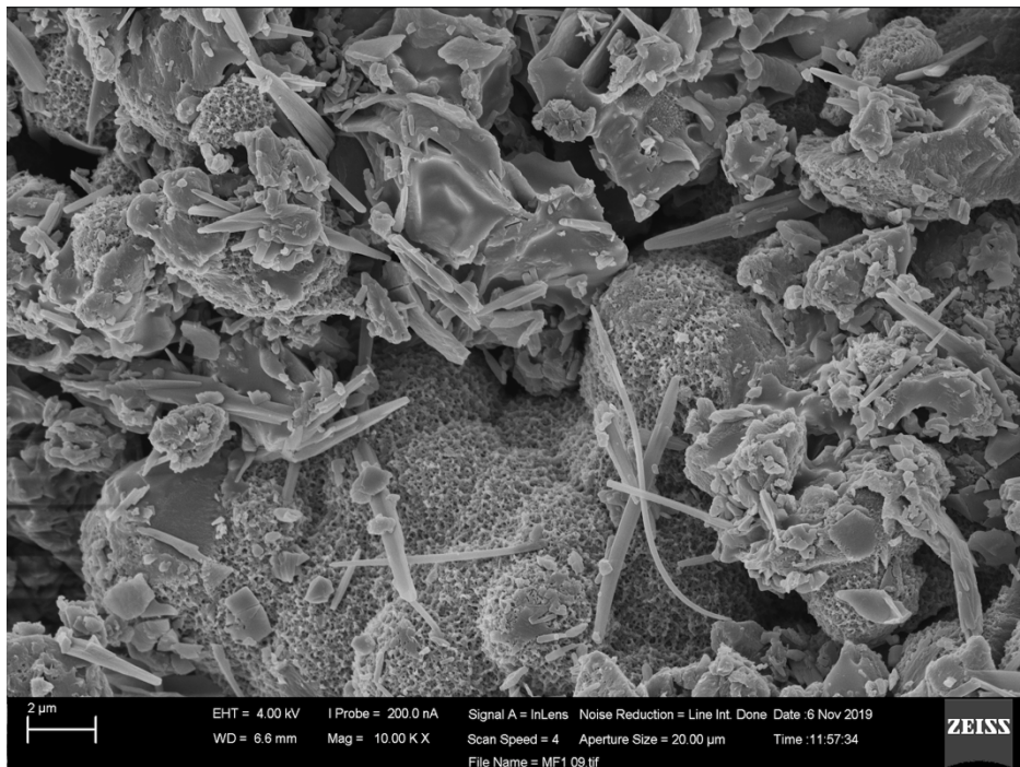
Figura 20: Imagem da POEA-ES (10 kX) mostrando a presença de microplacas, microfibras e grânulos.
