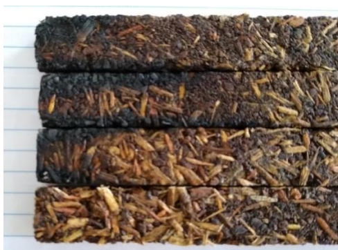
Figura 23. Amostras após teste de inflamabilidade.
