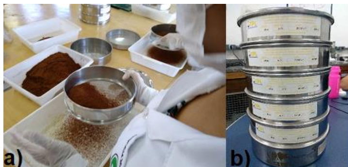
Figura 9: Realização da distribuição granulométrica. a) Peneiramento; b) Peneiras.
