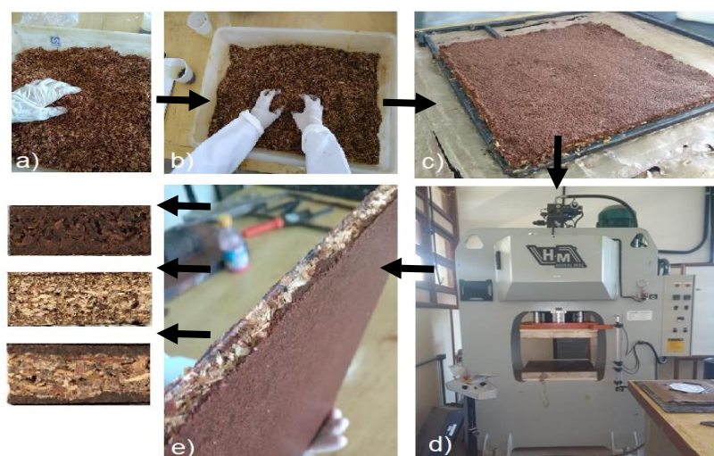
Figura 11: Metodologia de produção das placas; a) Mistura dos resíduos; b) Mistura manual dos resíduos com a resina. c) Deposição da mistura no molde; d) Conformação utilizando prensa hidráulica; e) Corpos de prova.
