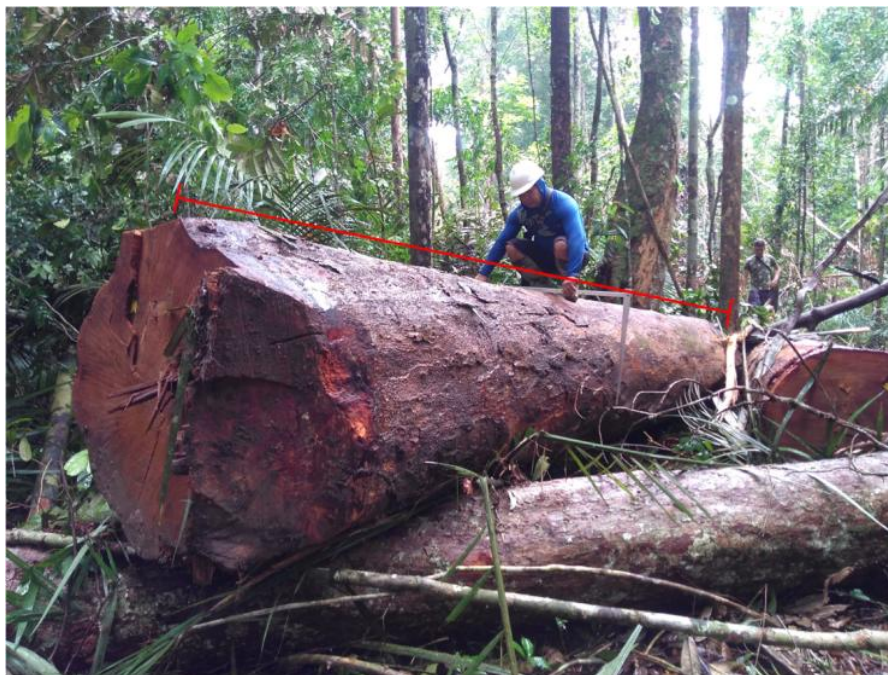
Figura 09. Mensuração do diâmetro no ponto médio da seção pelo método de Huber Fonte: acervo pessoal
