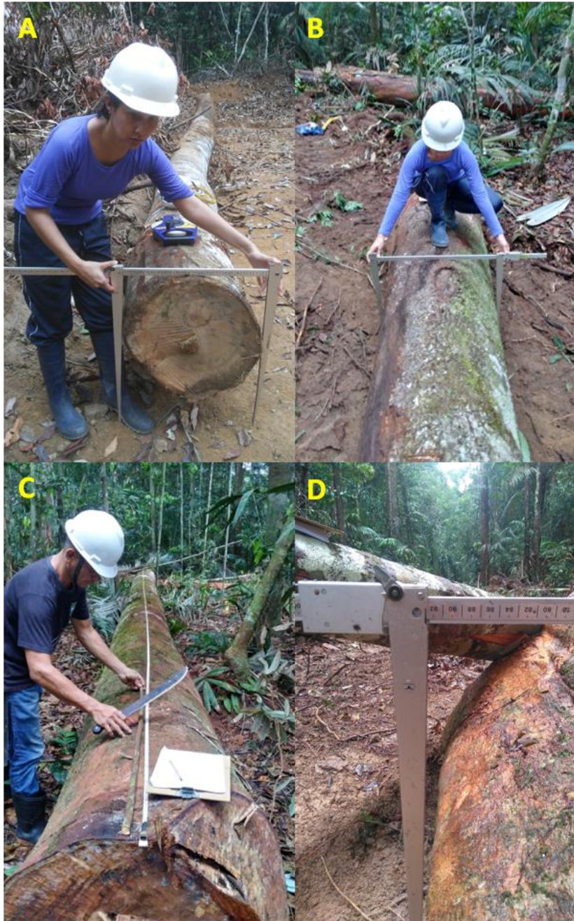
Figura 07. Método combinado. a) Mensuração das extremidades b) Mensuração das seções com a suta c) Divisão do comprimento da tora em 10 partes de mesmo comprimento e d) Leitura do diâmetro em cada seção. Fonte: acervo pessoal
