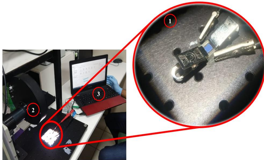
Figura 16. Arranjo experimental para obtenção dos parâmetros de eficiência das células fotossensibilizadas. (1) célula conectada aos devidos polos; (2) simulador solar; (3) Notebook e Software NOVA 2.0.
