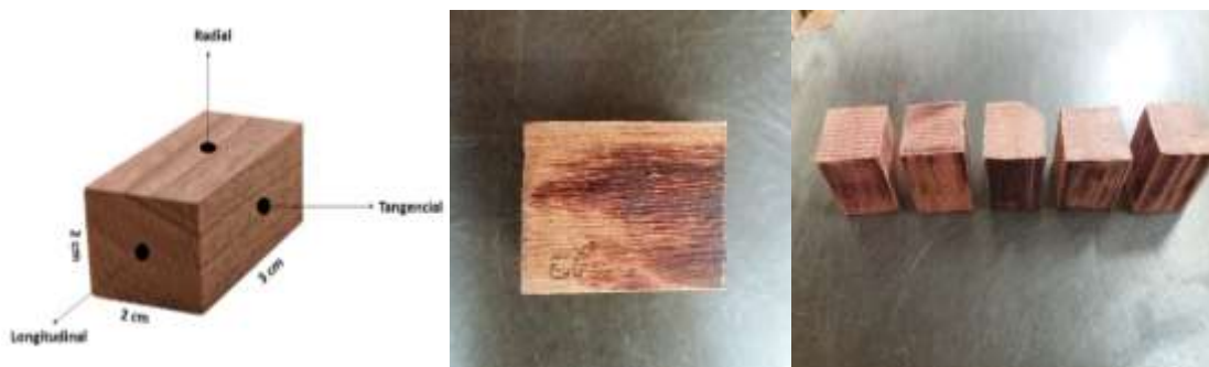
Figura 4. Aspecto dos corpos de prova para a determinação da densidade básica e estabilidade dimensional. Total de cinco amostras por espécie.
