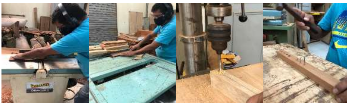
Figura 6. (A) Aplainamento; (B) Corte Serra; (C) Perfuração por brocas; (D) Perfuração por prego.
