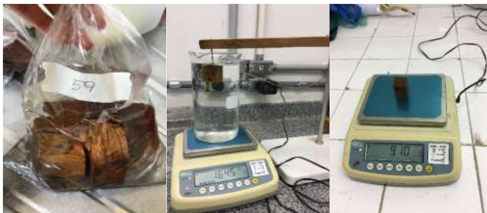
Figura 5. Determinação da densidade básica e Estabilidade dimensional. (A) Saturação das amostras; (B) Medição de volume pelo método da balança hidrostática; (C) Pesagem do peso seco.
