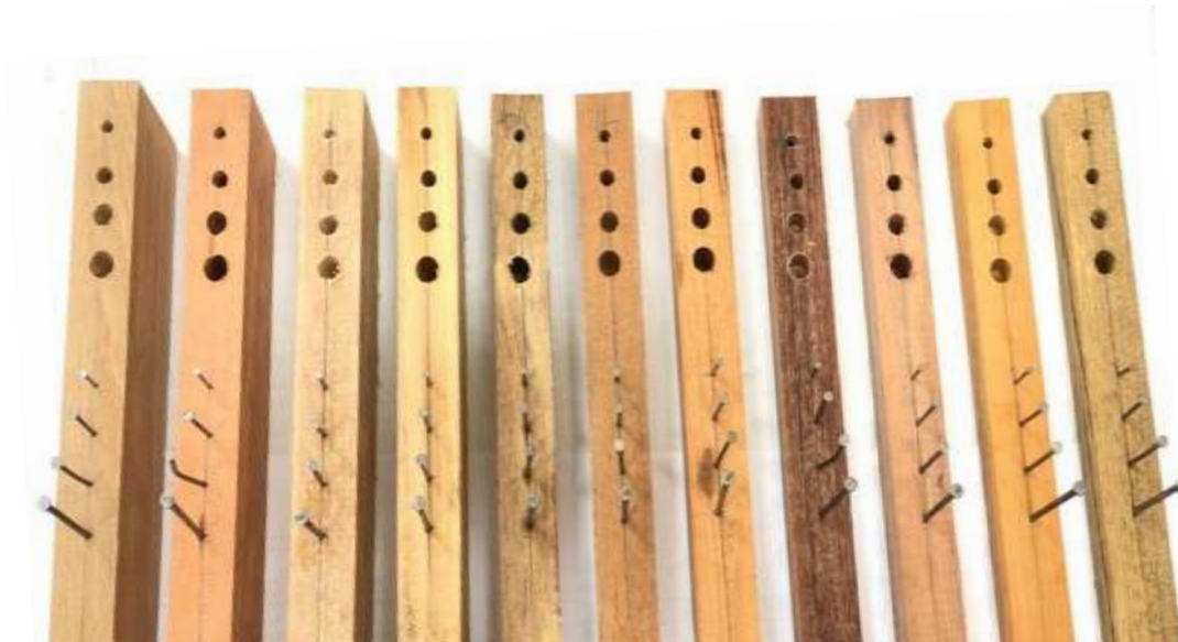
Figura 14. Resultado dos testes de perfuração e fendilhamento.
