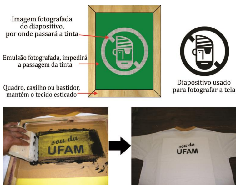
Figura 4- Princípio de Impressão da serigrafia
