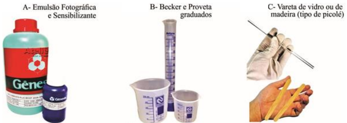
Figura 59 – Materiais do procedimento do emulsionamento da tela,
