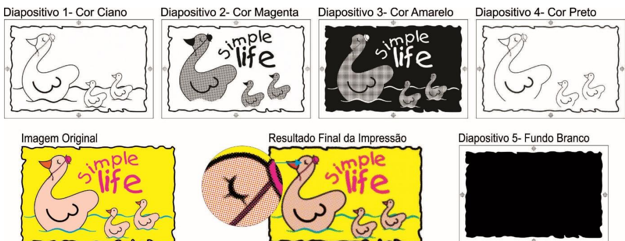
Figura 56 - Separação dos diapositivos da Quadricromia
