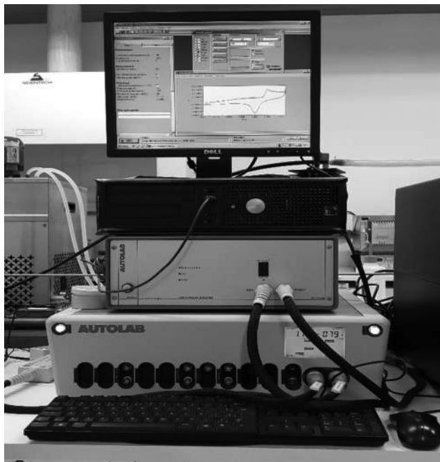
Figura 12 - Potenciostato AutoLab modelo PGSTAT 302N.
