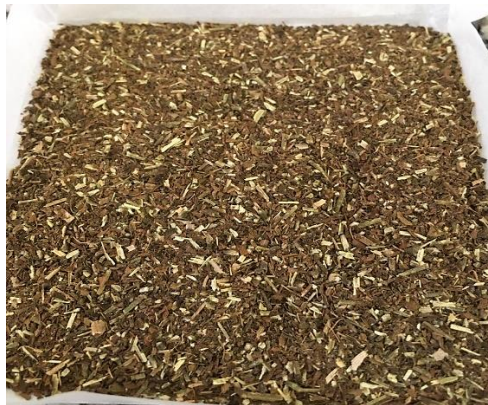
Figura 6 - MPV obtida após moagem em moinho de facas com peneira de 2mm.
