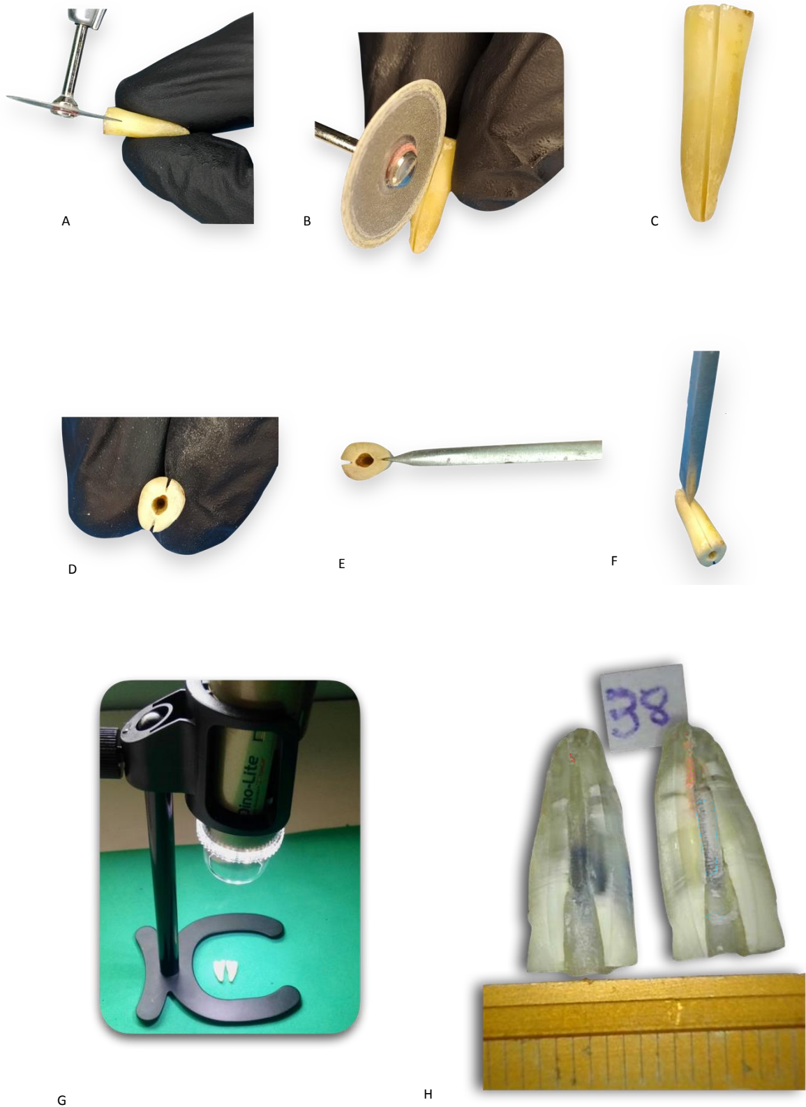
Figura 13- A e B) seqüência da confecção dos sulcos realizado disco diamantado dupla face total 22x0,20mm; C) sulco longitudinal; D) vista cervical dos sulcos; E e F) secção de dos corpos de prova com cinzel; G) captura de imagens pelo microscópio digital; H) raiz seccionada com resíduos de cone de guta-percha e pino de fibra de vidro, as áreas circundadas em verdes são resíduos de guta-percha, em azul pino de fibra de vidro e em vermelho cimento endodôntico e régua milimetrada para calibrar a aferição do programa.
