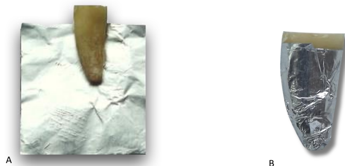
Figura 04- A) papel alumínio em posição sob o corpo de prova; B) revestimento com papel alumínio para evitar que o espécime seja aderido a resina acrílica.
