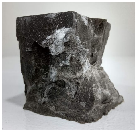
Figura 40 - Superfície de fratura do corpo de prova com eflorescência
