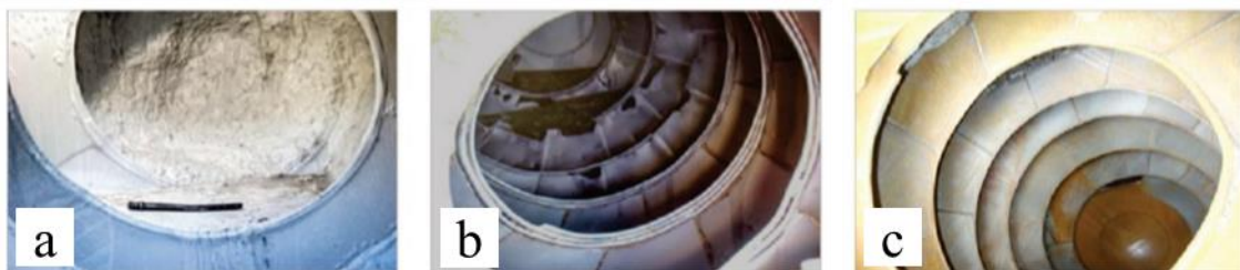
Figura 6 – Lavagem do caminhão betoneira: (a) material aderido, (b) material sendo removido e (c) tambor rotativo limpo.
