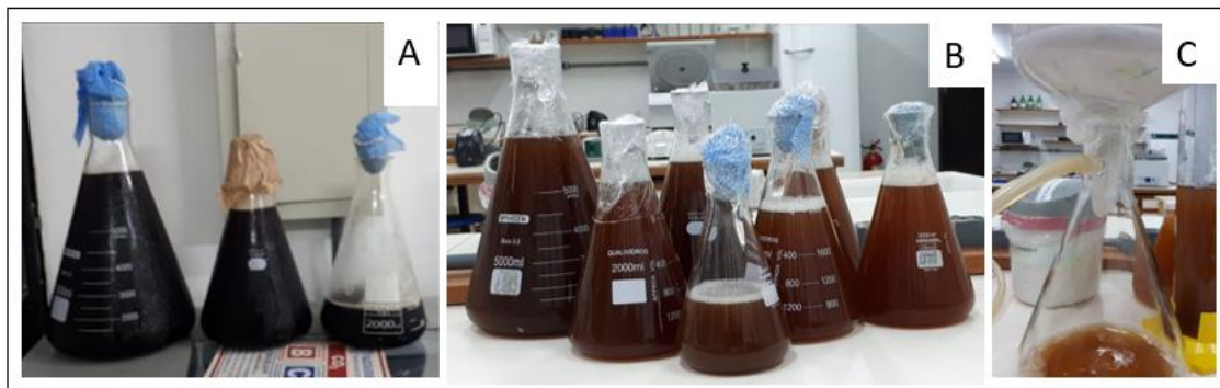
Figura 9. Volume final da produção de \alpha -amilase com meio otimizado (A); Volume final da produção de glucoamilase (B); Sistema de filtração à vácuo (C)
