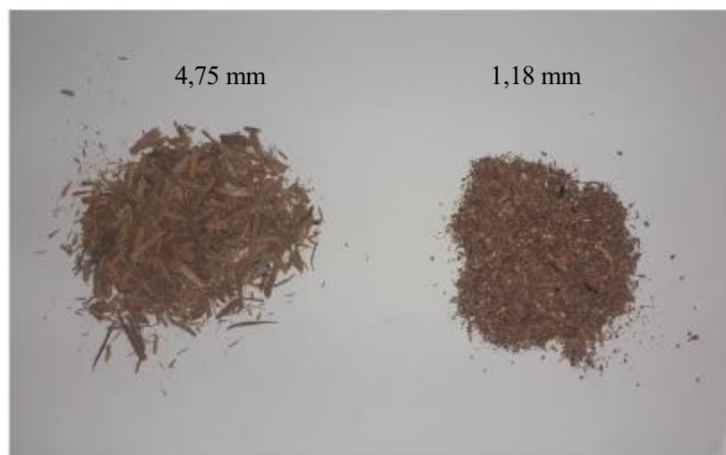
Figura 19 – Resíduos de Madeira separados nas granulometrias de 4,75 mm e 1,18 mm, respectivamente
