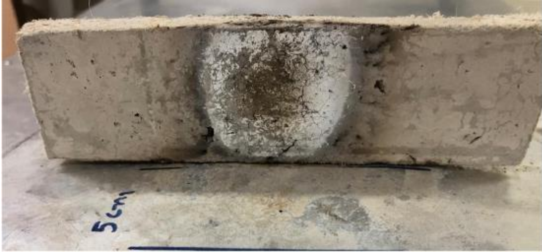
Figura 46 – Amostra após 140 minutos de incineração
