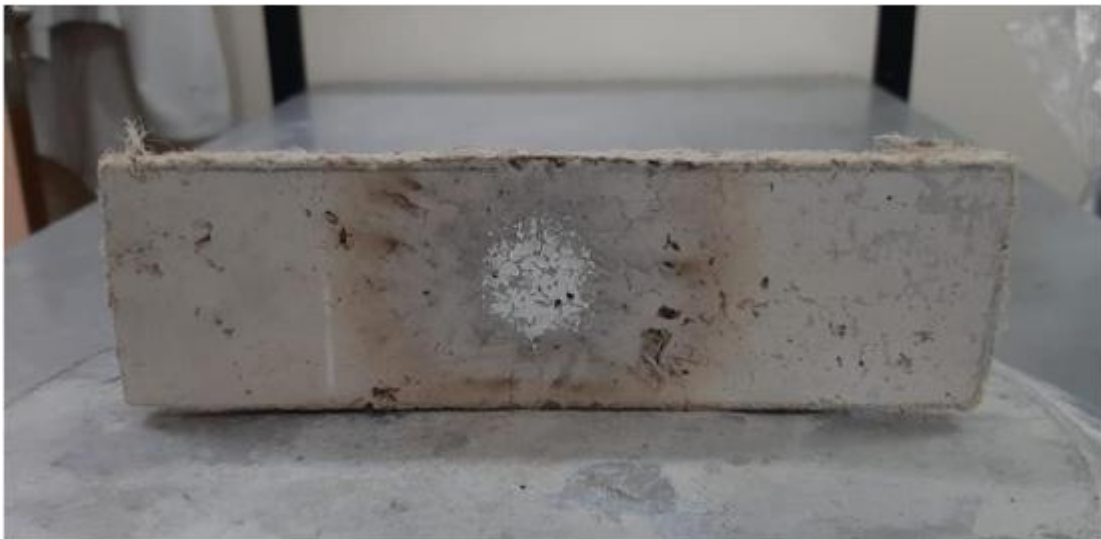
Figura 45 – Amostra após 40 minutos de incineração
