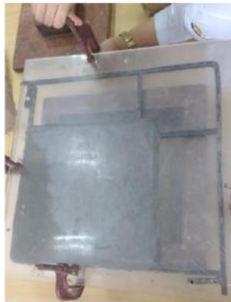
Figura 29 – Fechamento da forma de acrílico com graxos metálicos
