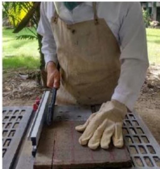
Figura 31 – Processo de corte das amostras
