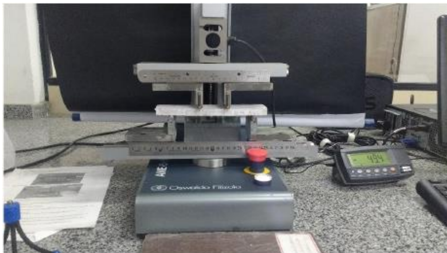
Figura 33 – Equipamento modelo AME-5kN marca Owvaldo Filizola, para ensaio de Flexão
