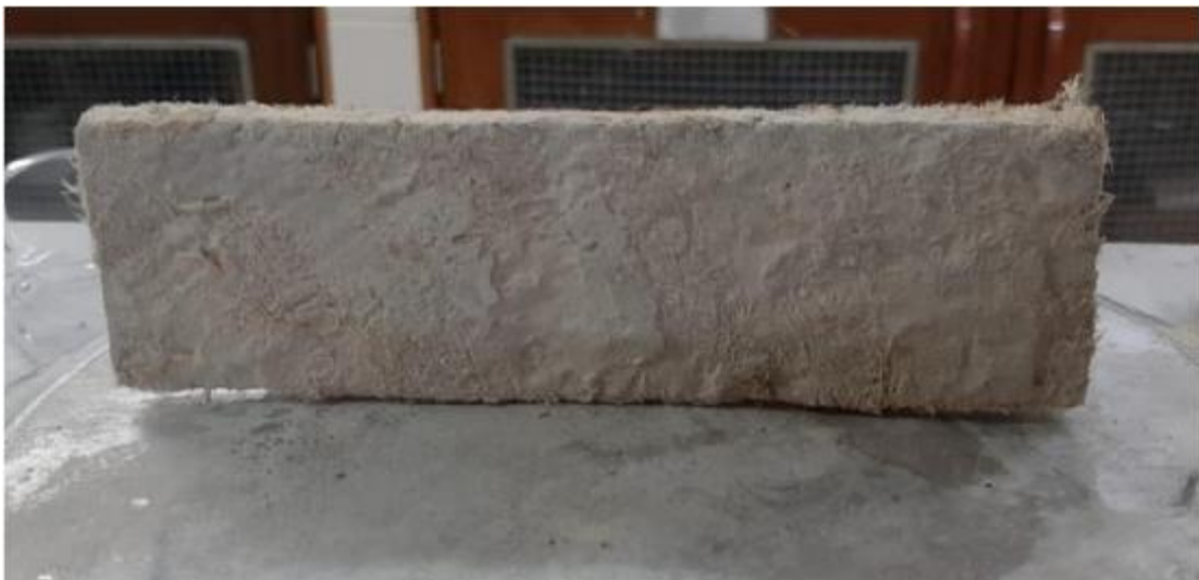
Figura 47 – Parte traseira do ponto de incineração da amostra após 140 minutos
