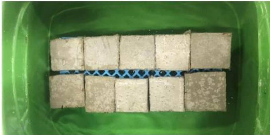
Figura 35 – Amostras em processo de saturação
