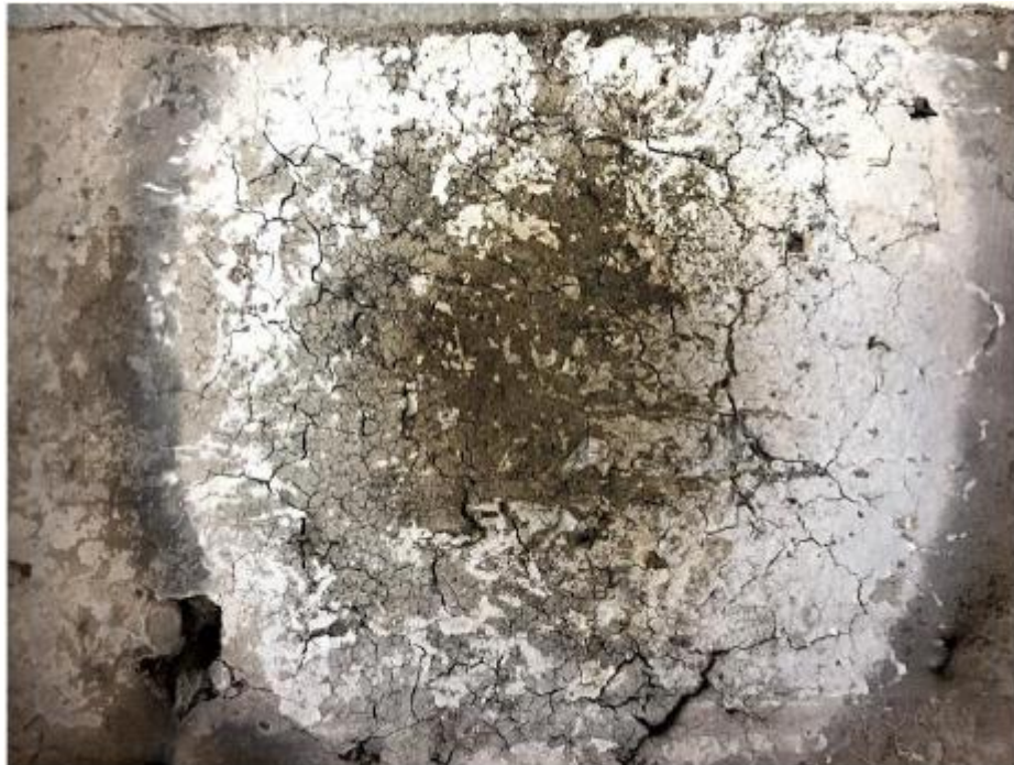
Figura 49 – Demonstração das microfissuras aparentes da amostra pós ensaio
