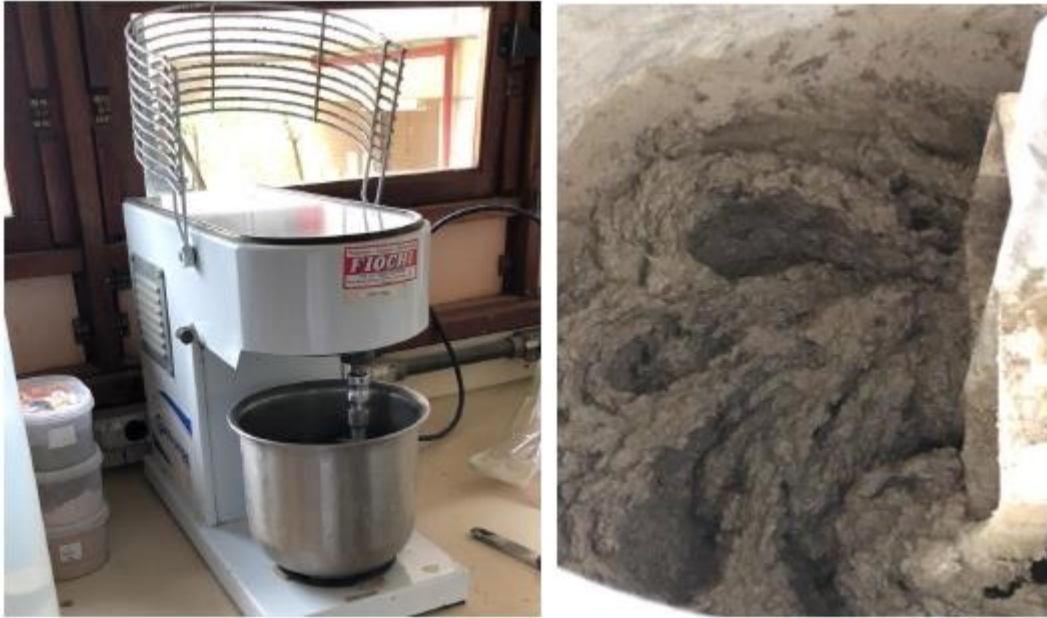
Figura 26 – Mistura do resíduo de madeira até consistência pastosa
