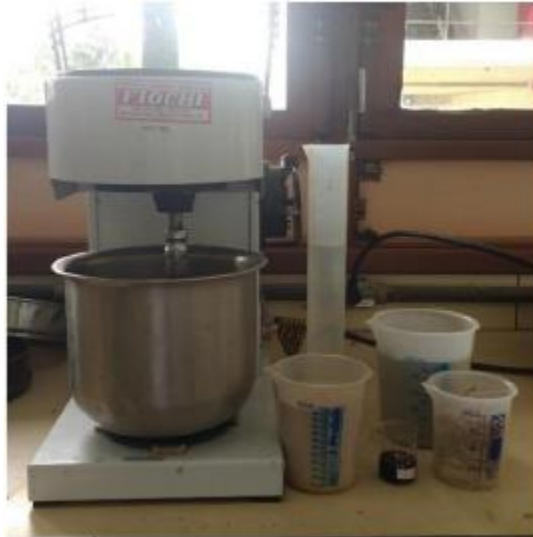
Figura 24 – Materiais pesados e separados, equipamento utilizado para mistura
