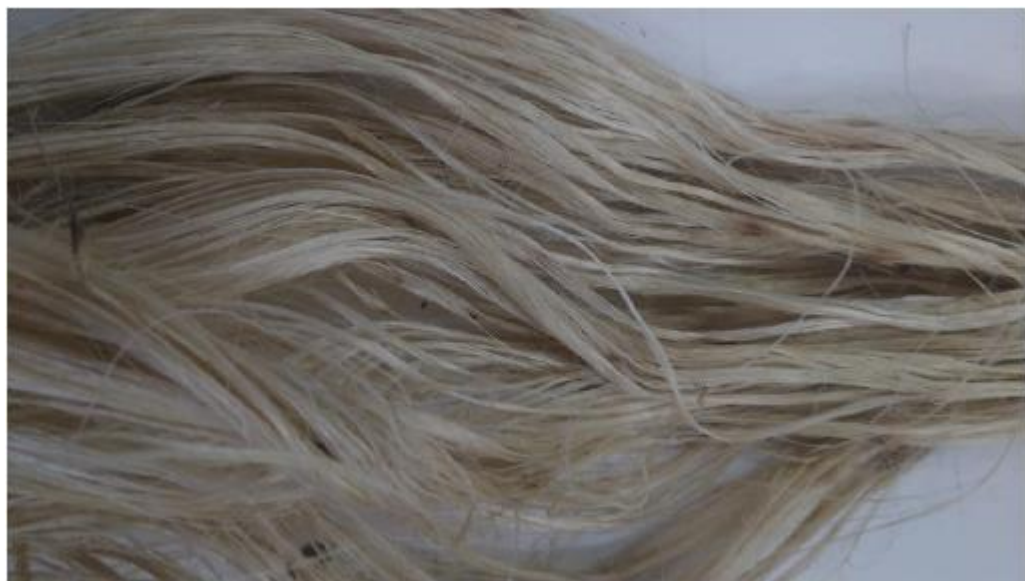
Figura 18 – Fibra de Malva amazônica lavada e seca
