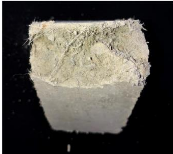
Figura 43 – Amostras M0FM após tempo de inércia e ensaio de flexão X deflexão
