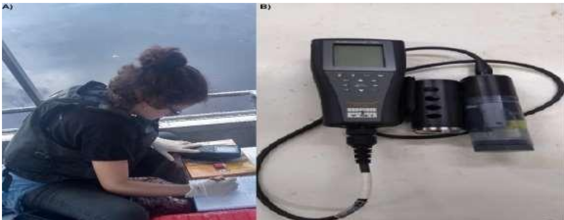
Figura 7: A) Medições multiparamétricas no ponto amostral B) Sonda multiparamétrica YSI professional Plus utilizada nas medições no campo.
