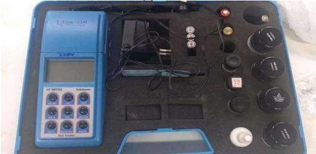
Figura 9: Turbidímetro com suas respectivas cubetas e soluções padrão para calibração do equipamento
