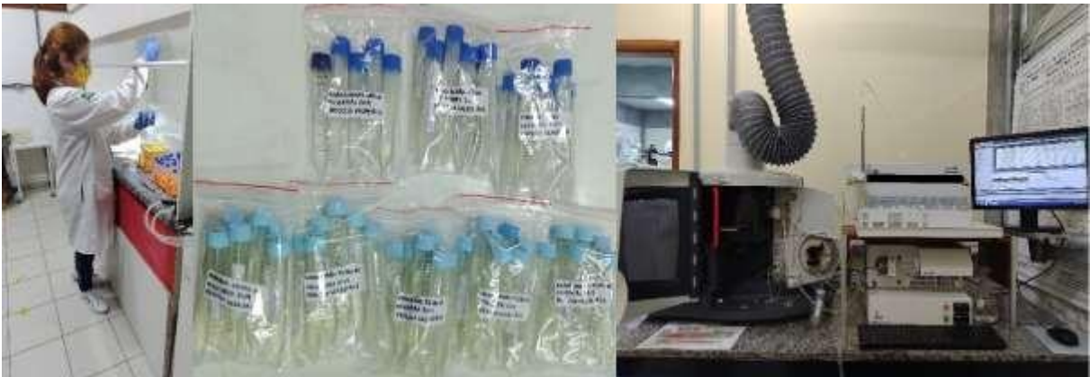
Figura 12: Etapas de preparação de amostras de águas superficiais e sólidos suspensos para análise no ICP-IOES.
