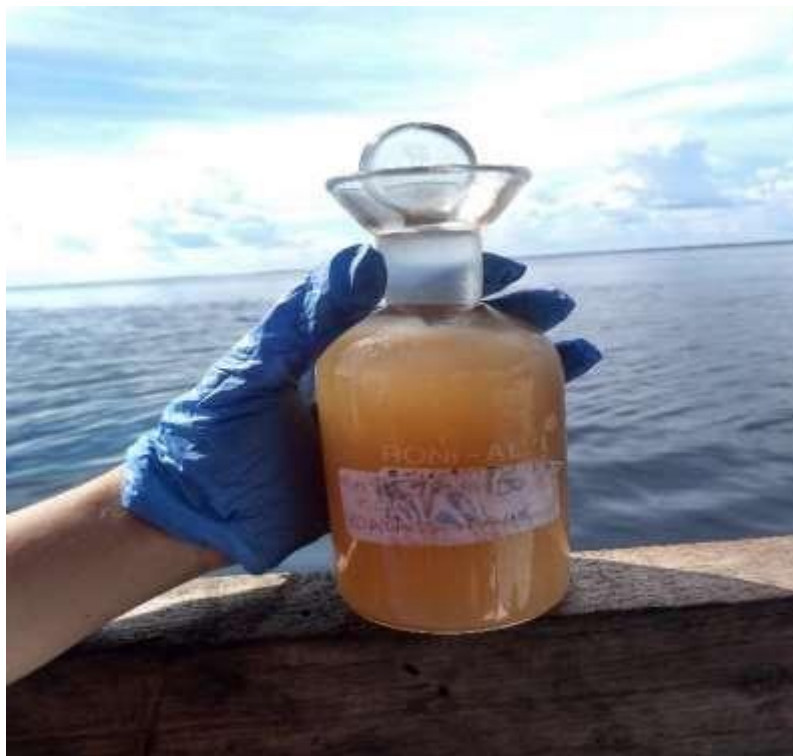
Figura 8: Frasco Winkler com oxigênio fixado na amostra
