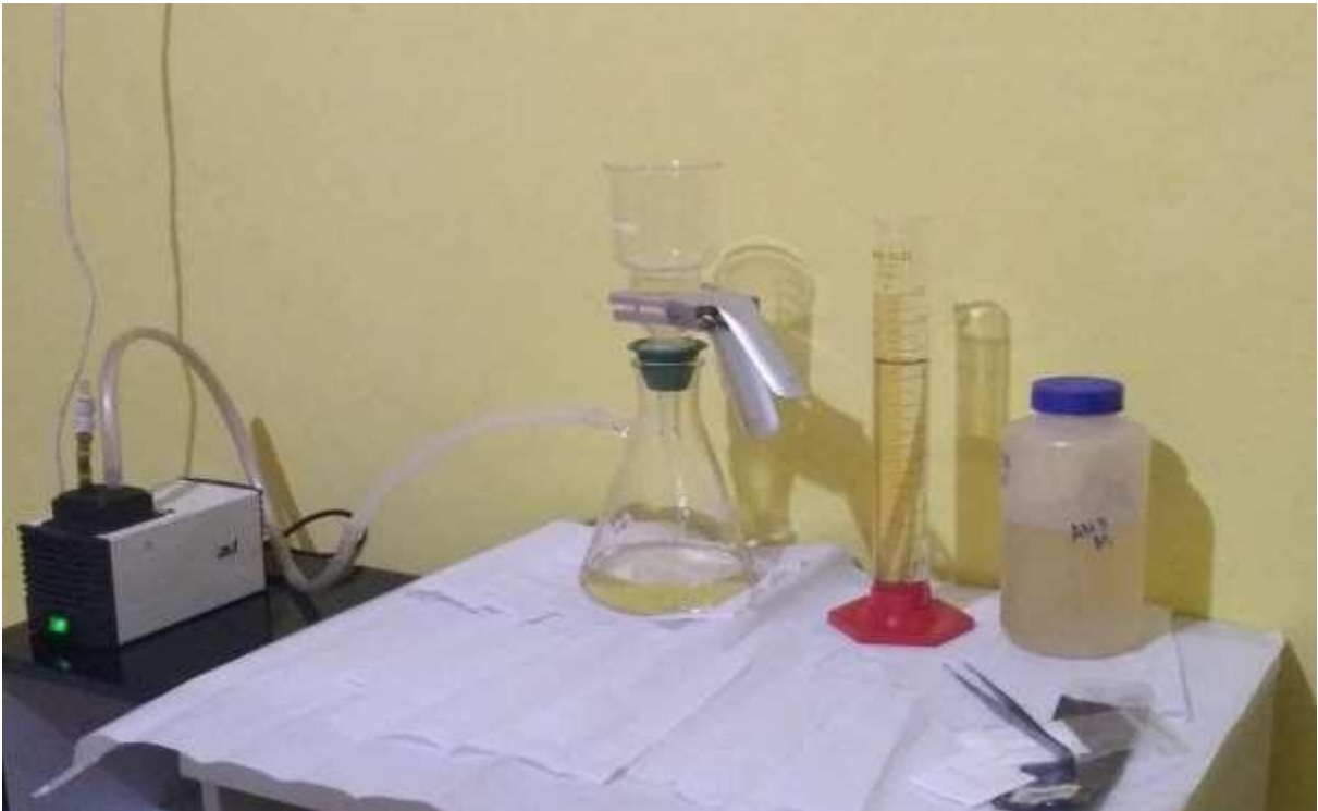
Figura 10: Sistema de filtração de água para determinação de STS
