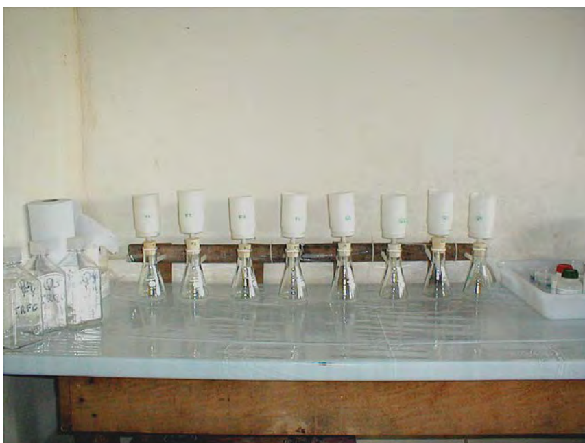
Figura B.1. Conjunto de sistemas de filtração em série. Fonte: M.C.Forti
