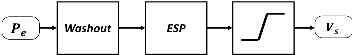
Figura 2.4: Estágios do estabilizador de sistemas elétricos de potência. Fonte: Adaptado de (Ayres Junior, 2014).
