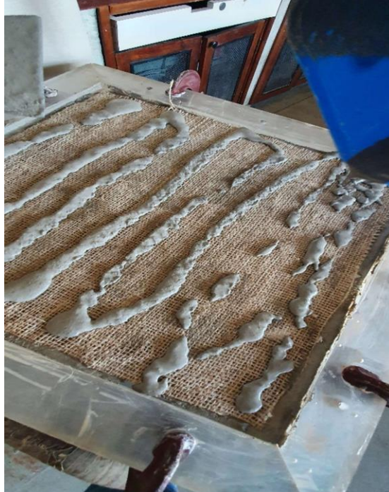
Figura 33 - Produção da placas reforçadas com tecidos fibrosos
