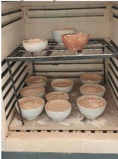
Figura 22 - Argila sendo calcinada
