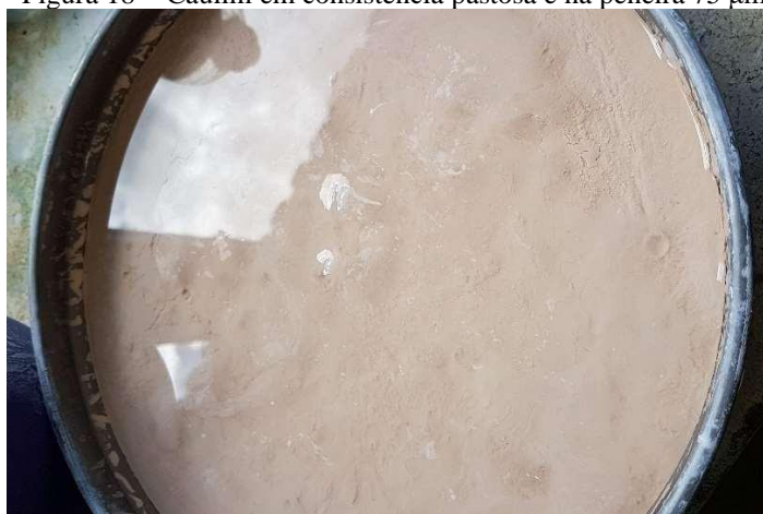
Figura 18 - Caulim em consistência pastosa e na peneira 75 \mu\text{m}
