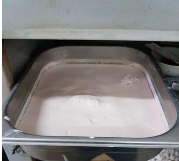
Figura 20 - Secagem da pasta de caulim na estufa a 110 °C
