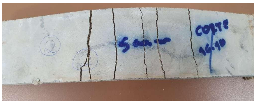
Figura 52 - Placa com 5 camadas não tratadas (M505T0)
