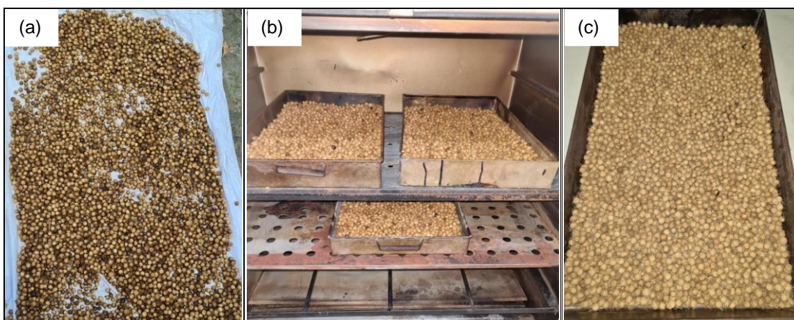
Figura 12 – Etapas de preparação dos caroços para moagem: (a) resíduos após primeira lavagem (b) secagem em estufa por 24 horas (c) resíduos totalmente secos.
