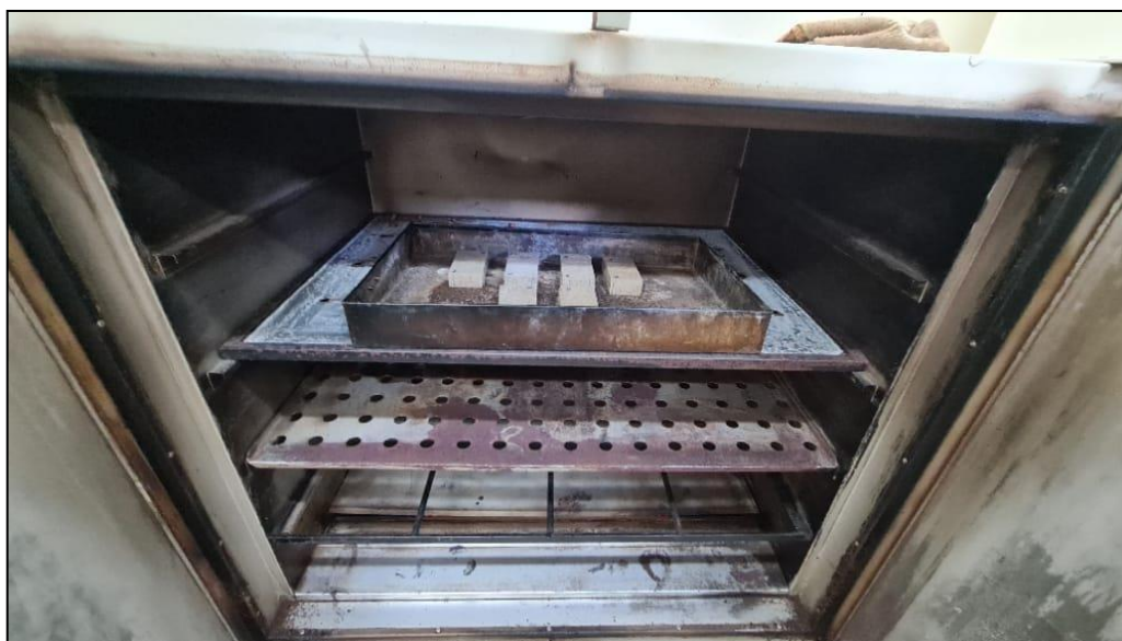
Figura 22 - Preparação dos corpos de prova para ensaio de absorção de água
