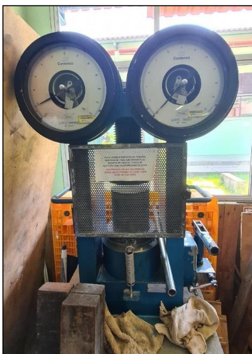
Figura 21 - Equipamento utilizado para obter a resistência à compressão
