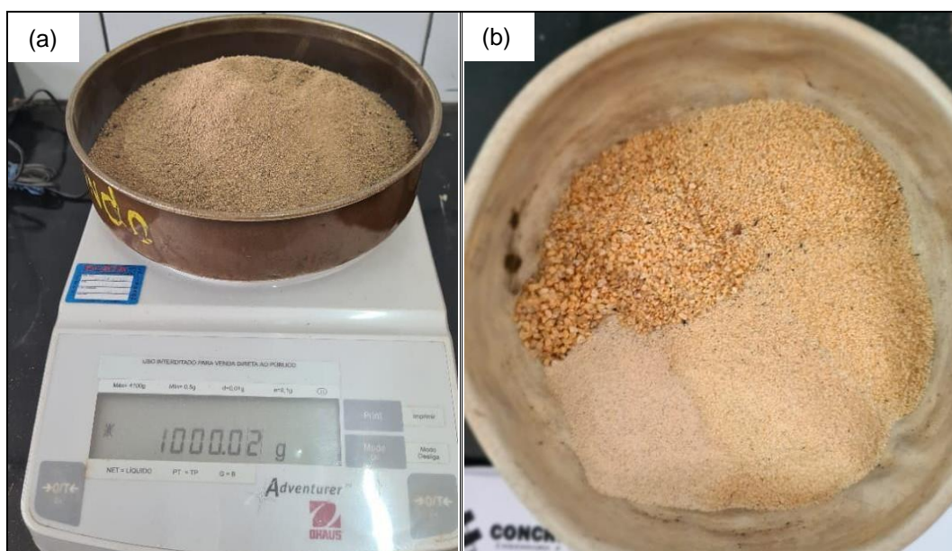
Figura 16 - Etapas do ensaio de granulometria dos solos (a) pesagem da amostra (b) diferença das granulometrias após ensaio
