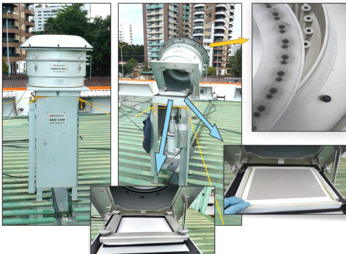
Figura 13. Amostrador de grande volume ( high-vol ) no local de coleta. A seta amarela mostra o disco poroso com partículas > 2,5 \mu m retidas no óleo mineral. As setas azuis indicam, em zoom próximo, a posição do filtro no equipamento, mostrando um filtro pré e pós amostragem.
