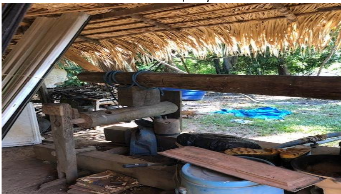
FIGURA 21 - Prensa essencial na produção da farinha de mandioca
