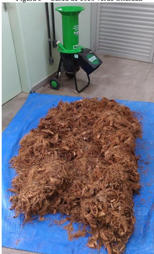
Figura 6 – Moagem da casca do coco verde: a) Moinho de facas utilizado para a moagem da casca de coco triturada; b) Coco verde moído
