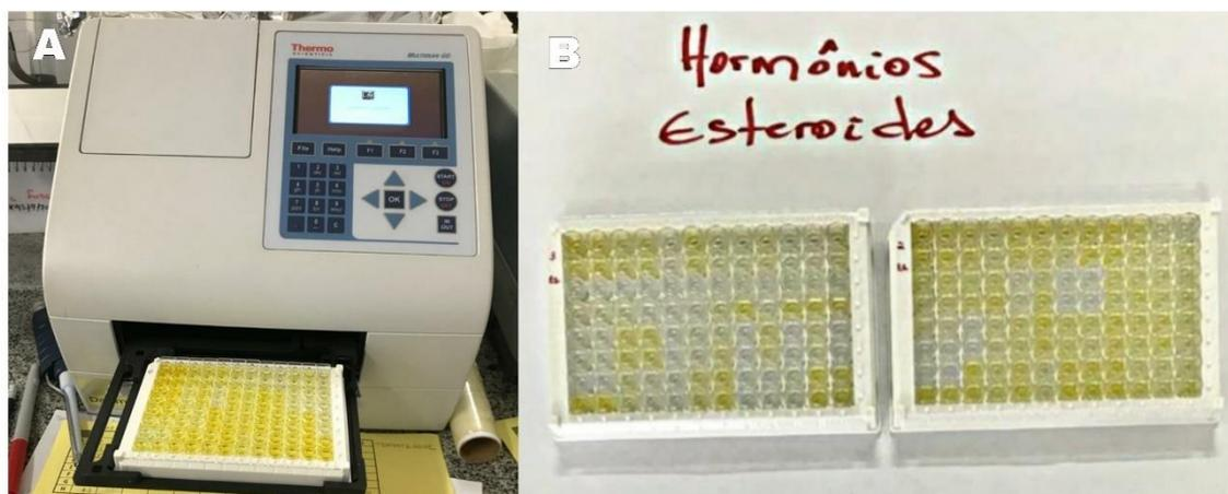
**Figura 5** - Análise hormonal do plasma de *Podocnemis expansa*. Espectrofotômetro de microplaca (A); Placas de testosterona e estradiol após a leitura (B). Fonte: Lopes, T. 2021
