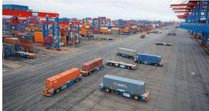
Figura 8 – Exemplo AGV em terminal de transporte de carga
